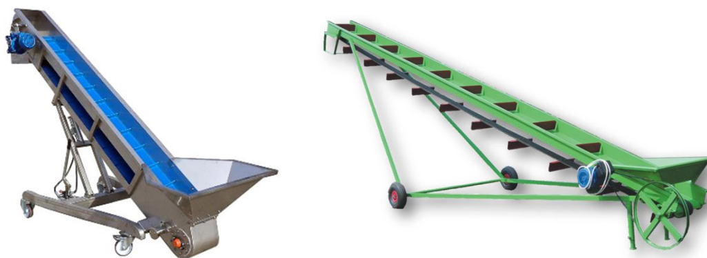
Slika 5.4 Primjeri komercijalnih trakastih transportera za rasuti teret
