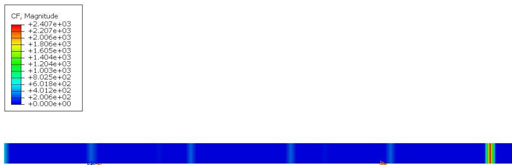
Slika 8.30 Prikaz koncentriranih sila na modelu grede nosača
