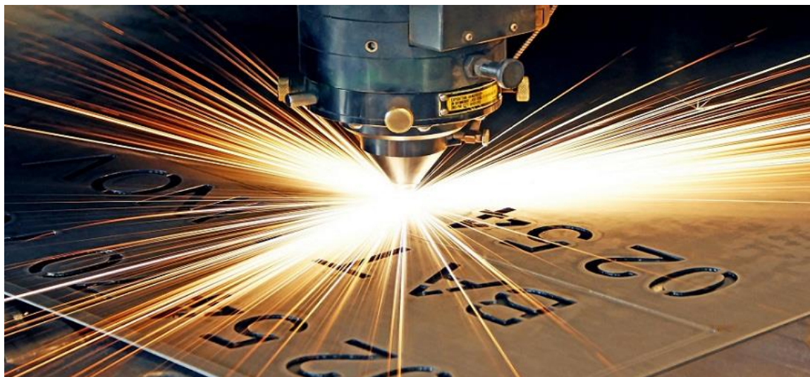
Slika 1. Lasersko rezanje čelika [2]
