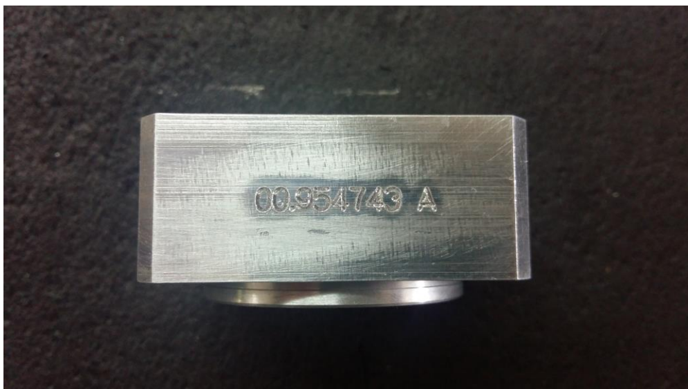
Slika 27. Primjer gravure na gotovom proizvodu
