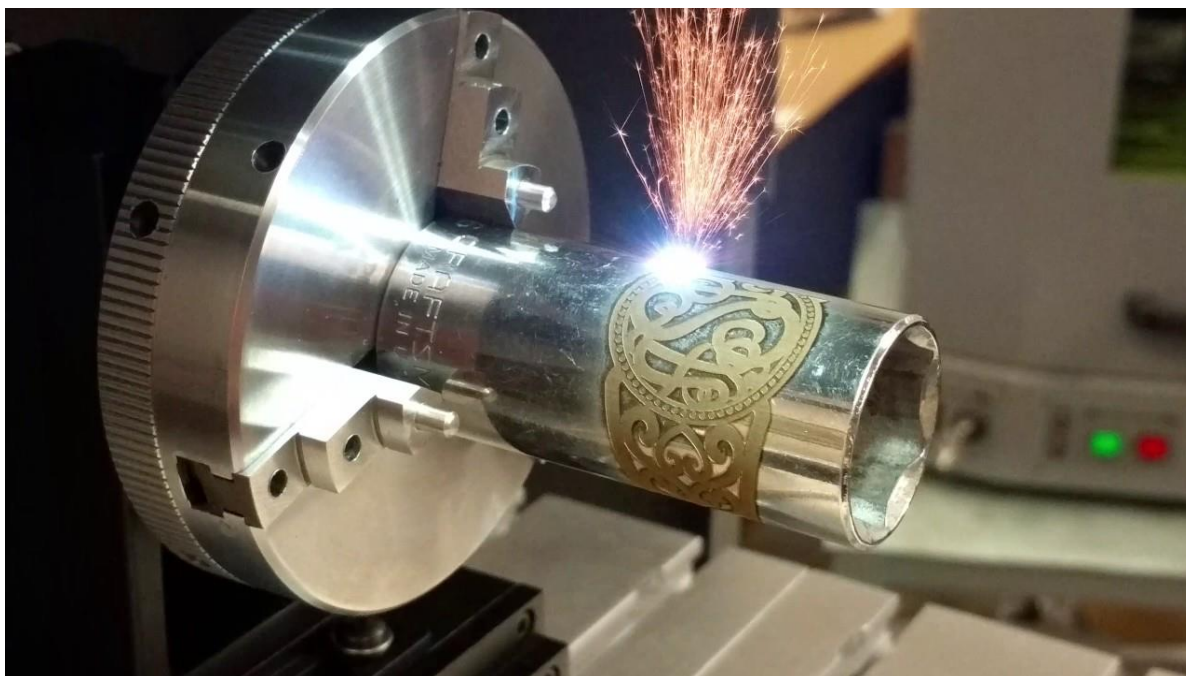
Slika 76. Primjer označavanja obradaka po njihovom obodu [33]
