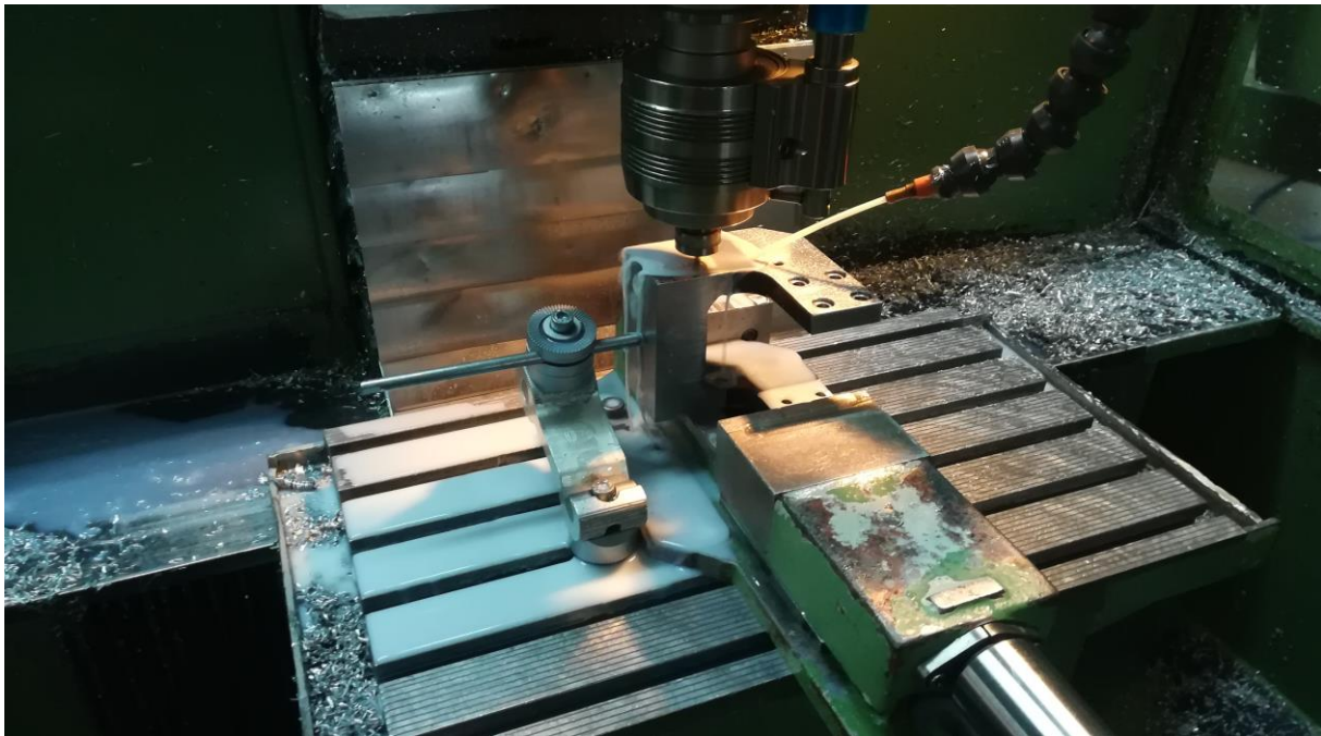
Slika 28. Graviranje na numerički upravljanoj glodalici
