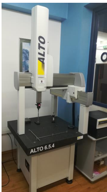
Slika 9. Numerički upravljani trokoordinatni mjerni uređaj tvrtke Nikon
