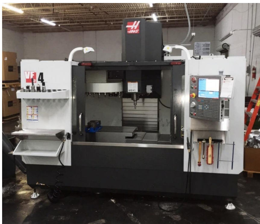
Slika 16. Glodaći obradni centar Haas [5]
