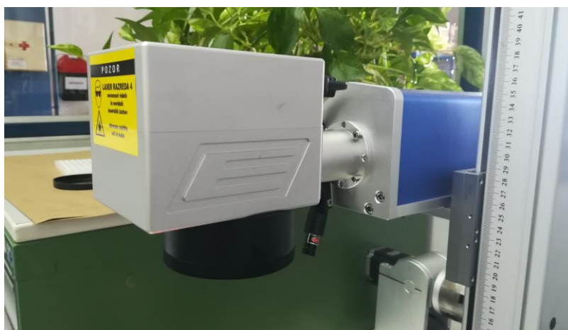
Slika 53. Laserska glava za označavanje obradaka
