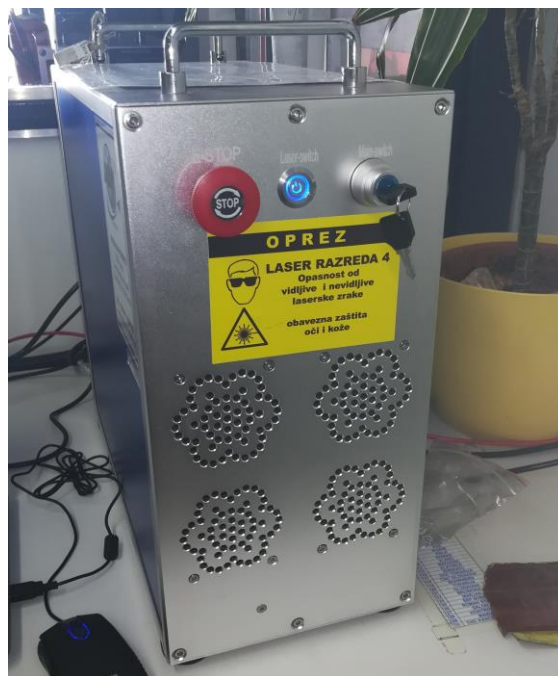
Slika 52. Izvor napajanja laserskog sustava za označavanje
