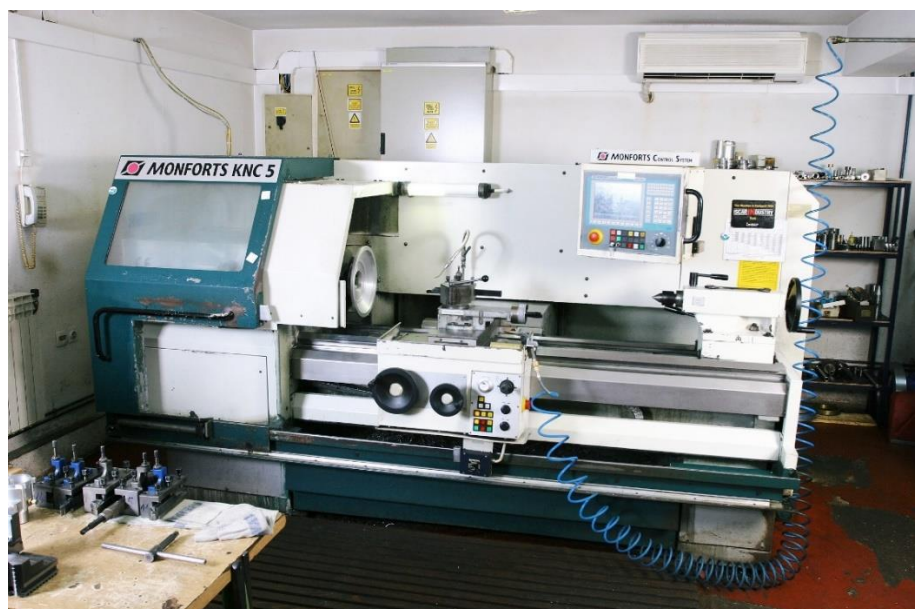
Slika 19. CNC tokarilica Monforts
