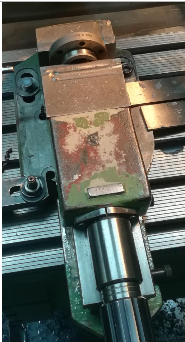
Slika 87. Stezanje proizvoda na numerički upravljanoj glodalici
