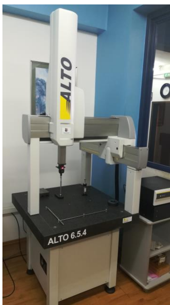
Slika 9. Numerički upravljani trokoordinatni mjerni uređaj tvrtke Nikon
