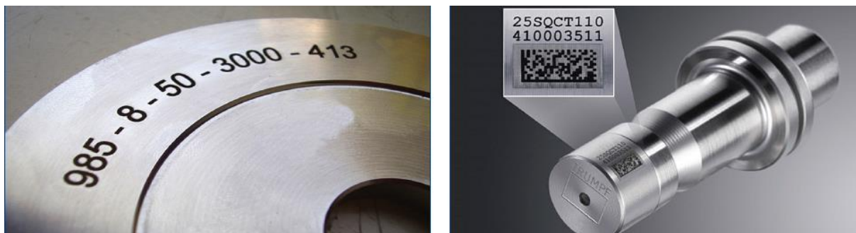
Slika 36. Primjer oznake na planskoj i cilindričnoj površini [7]
