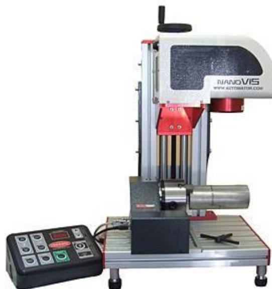
Slika 46. Laserski sustav za označavanje tvrtke Automator s pomoćnom rotacijskom osi [26]
