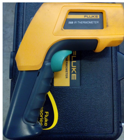
Slika 10. Fluke S68 uređaj za mjerenje međuprolazne temperature
