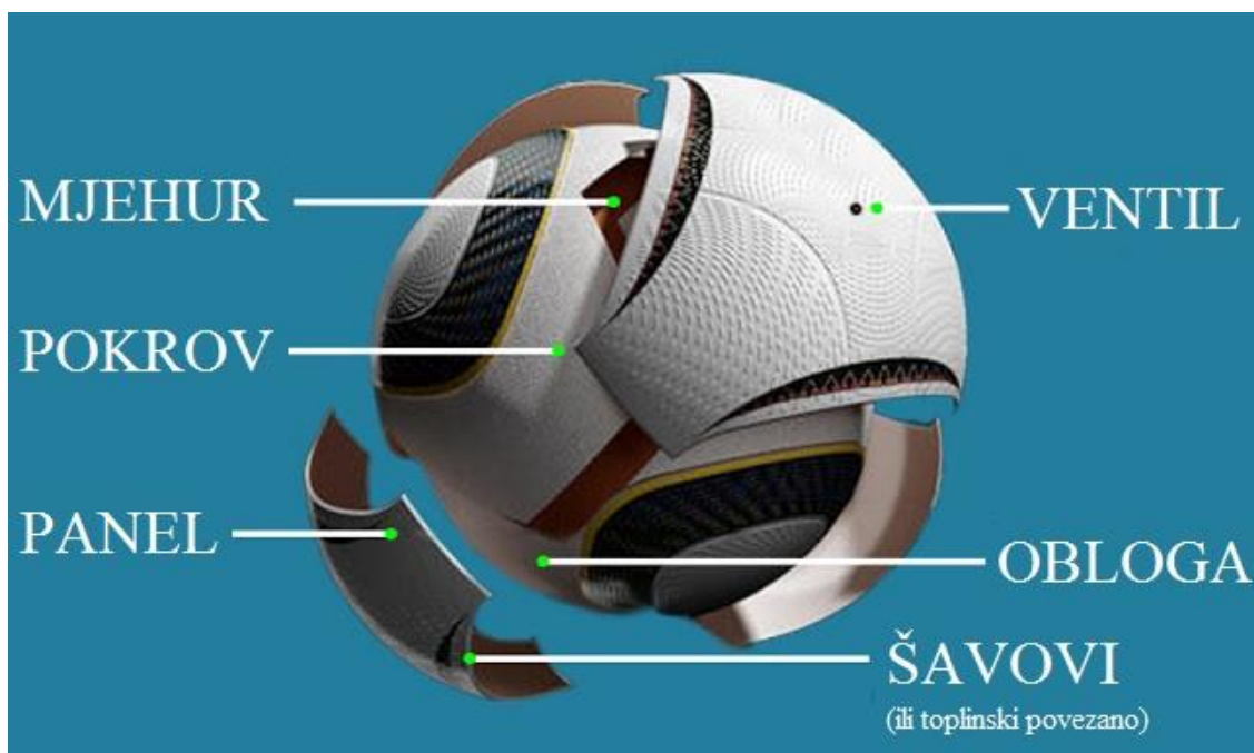
Slika 23. Konstrukcija nogometne lopte [8]
