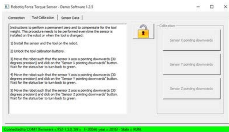
Slika 3.11. Kalibracija senzora putem eksternog računala (laptopa)
