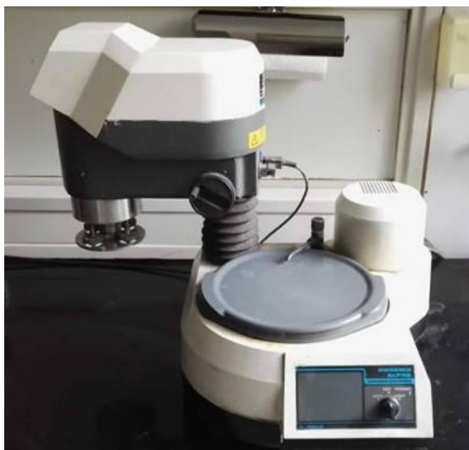
Slika 24. Buehler Phoenix Alpha uređaj za pripremu uzoraka
