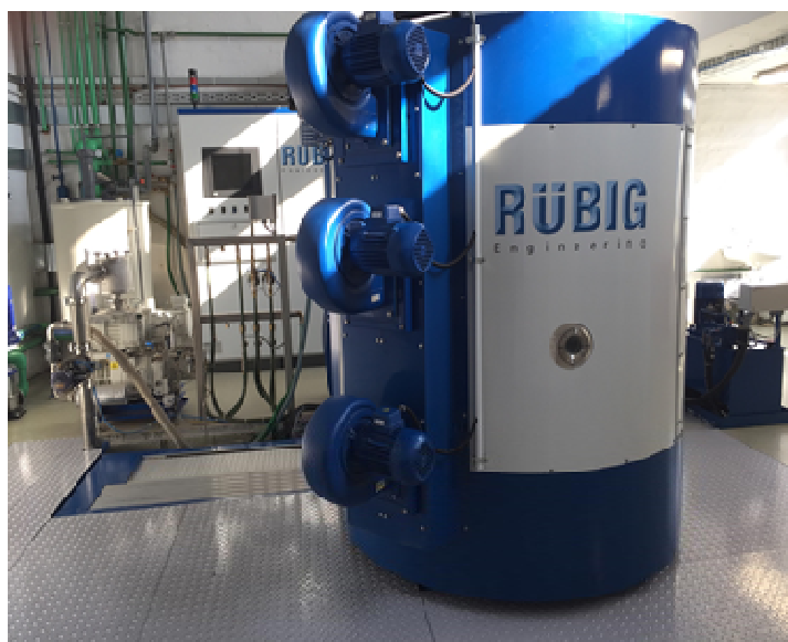
Slika 25. Industrijska peć RÜBIG GmbH Type PC 70/90 korištena za prevlačenje uzoraka
