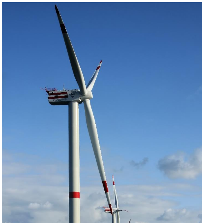
Slika 2. Prikaz vjetroagregata s horizontalnom osi vrtnje
