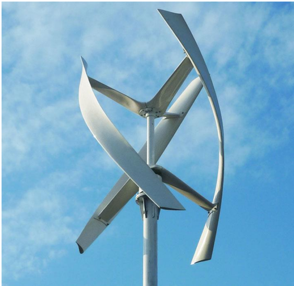
Slika 3. Prikaz vjetroagregata s vertikalnom osi vrtnje
