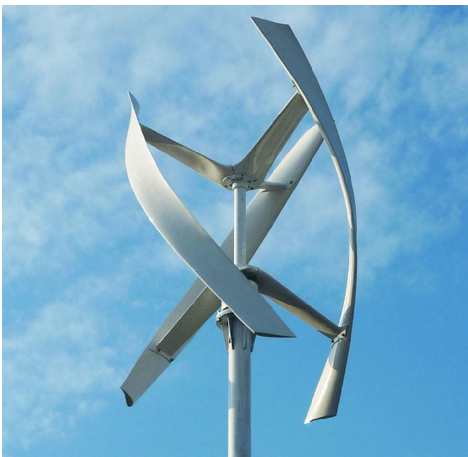
Slika 3. Prikaz vjetroagregata s vertikalnom osi vrtnje
