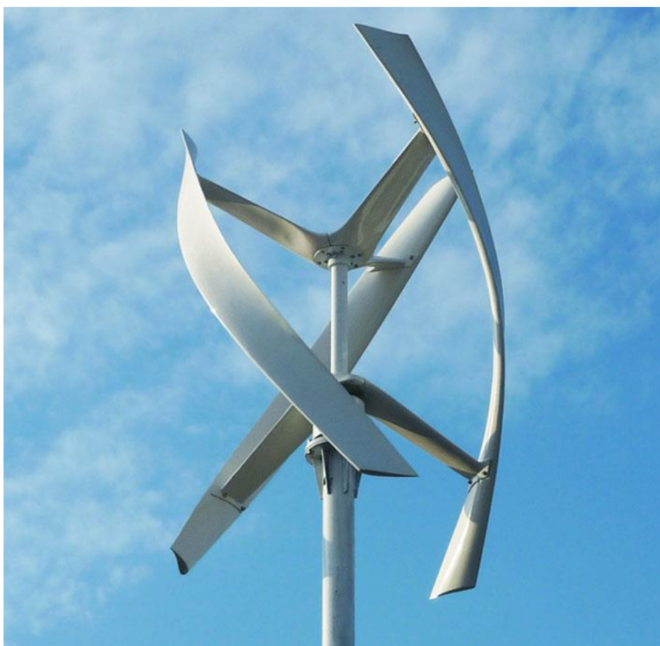
Slika 3. Prikaz vjetroagregata s vertikalnom osi vrtnje
