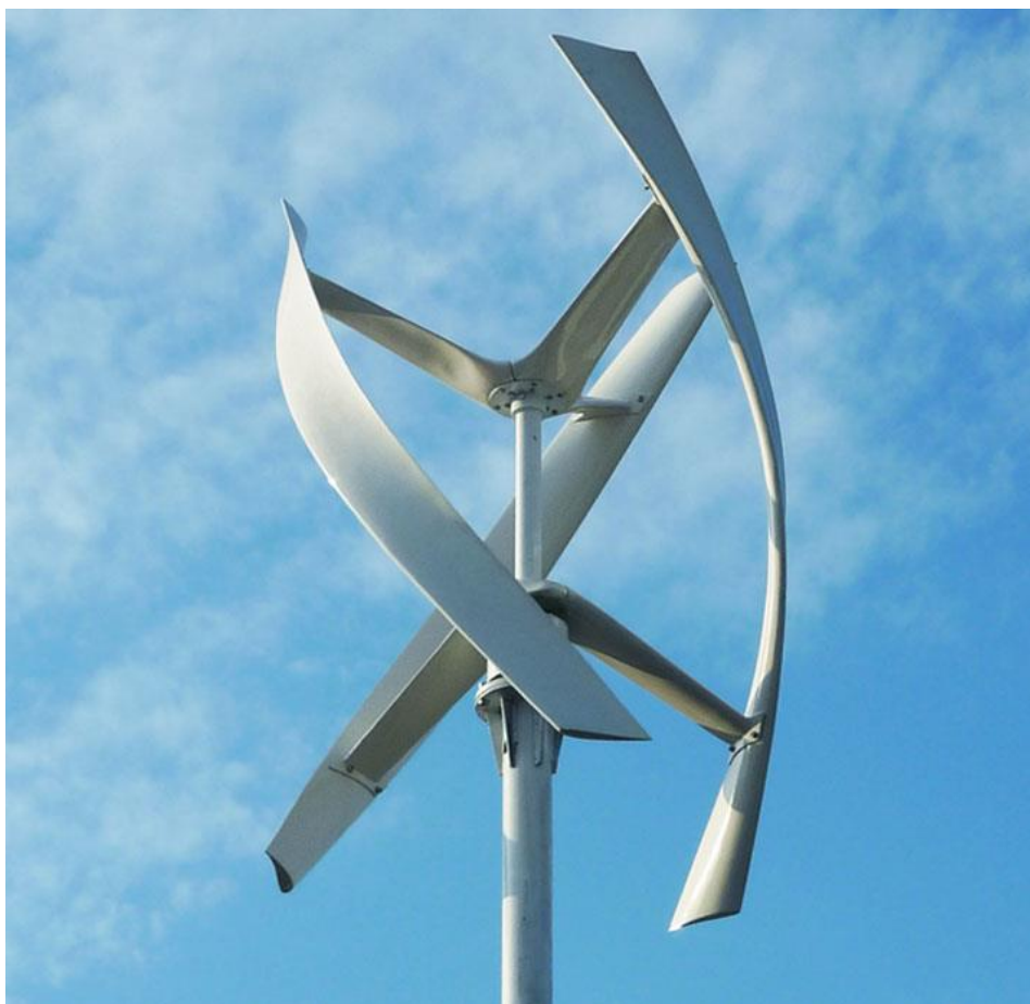
Slika 3. Prikaz vjetroagregata s vertikalnom osi vrtnje
