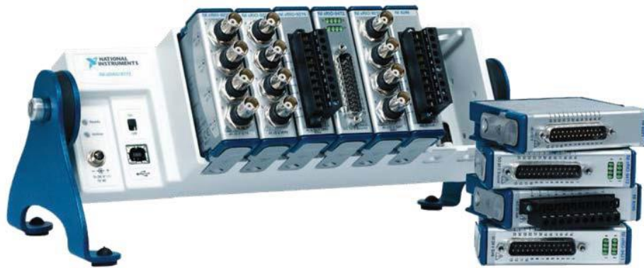
Slika 4.8 Mjerna stanica NI cDAQ-9178 [1]
