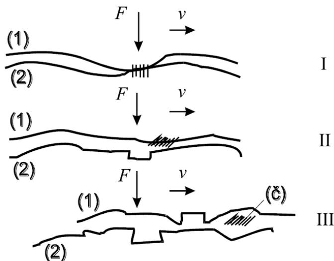
Slika 24. Adhezijsko trošenje [11]
