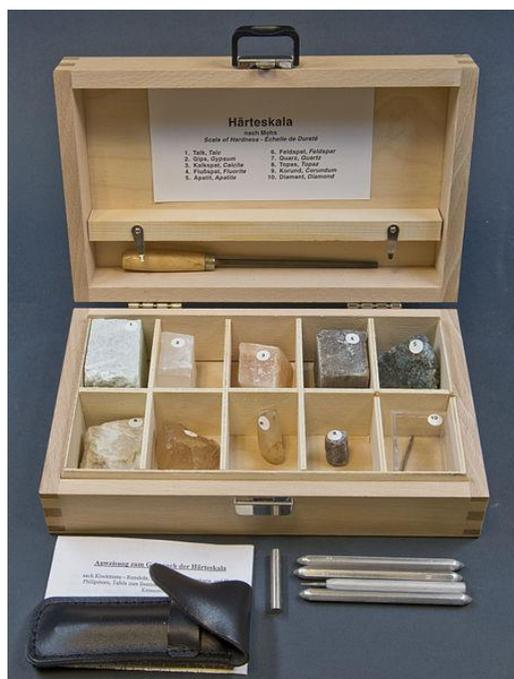
**Slika 10. Oprema za ispitivanje tvrdoće po Mohs-u [7]**
