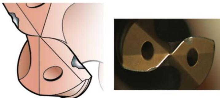
Slika 38. Lom na glavnoj reznoj oštrici [17]
