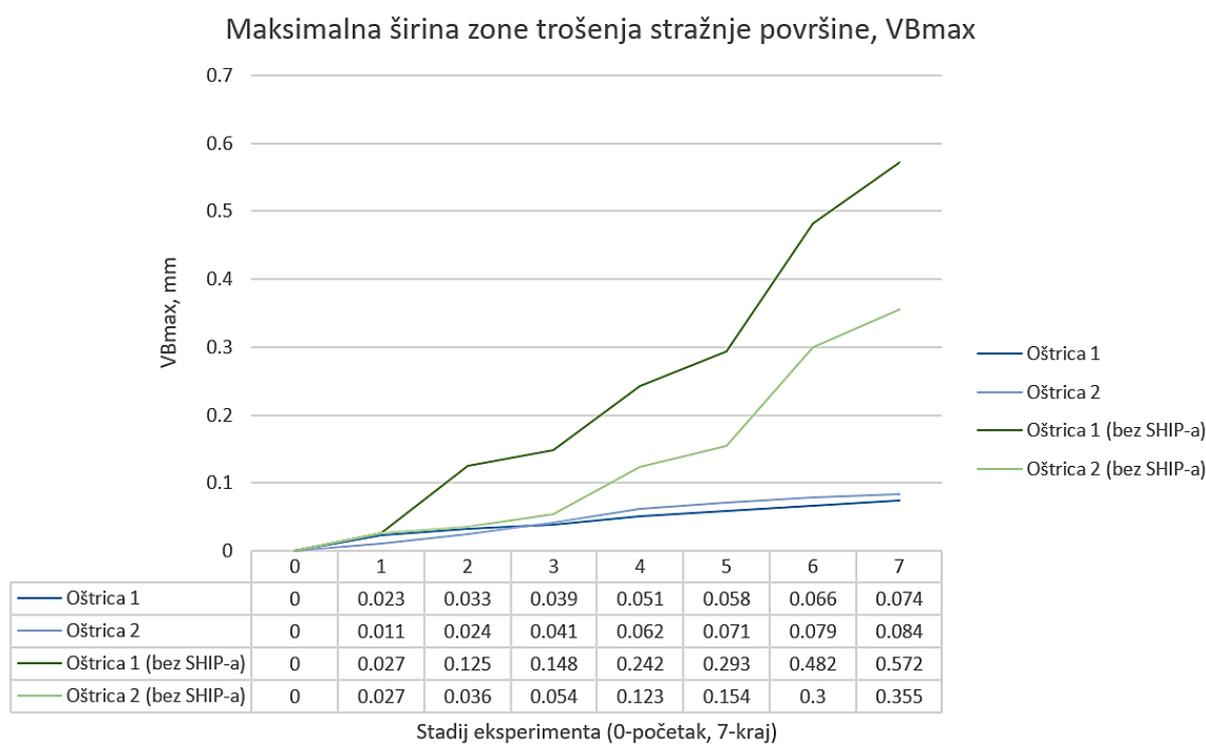
**Slika 79. Usporedba parametara trošenja stražnje površine alata s i bez primjene SHIP-a 2**
