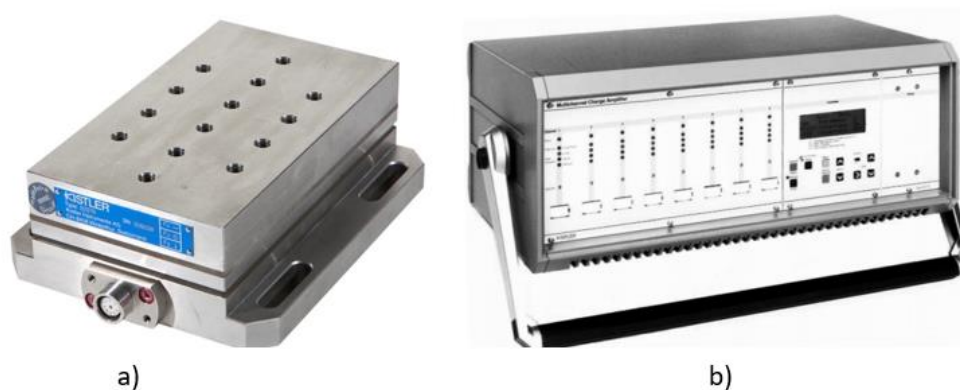
Slika 66. Senzor sila rezanja i nabojno pojačalo
