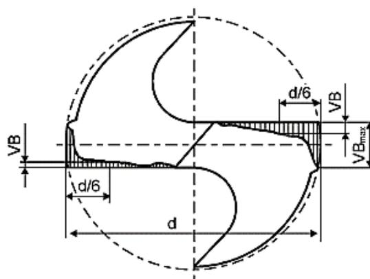
Slika 34. Parametri trošenja kod trošenja stražnje površine [18]
