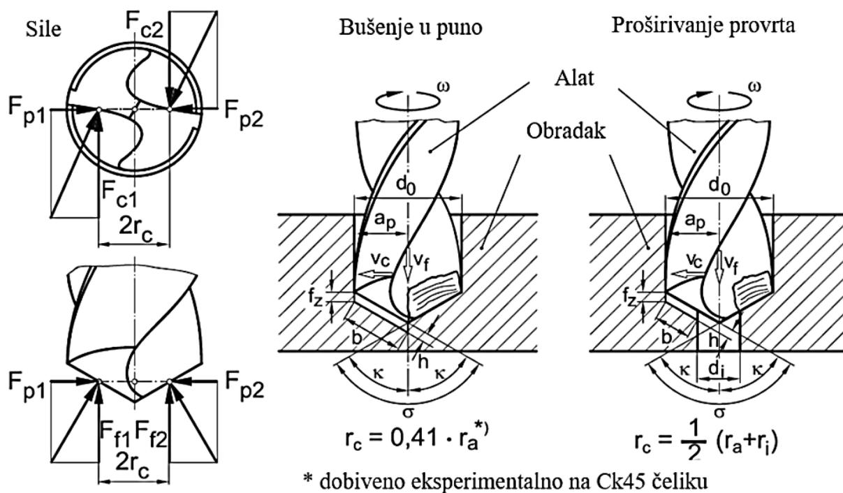
Slika 15. Geometrija odvojene čestice te sile kod bušenja [3]
