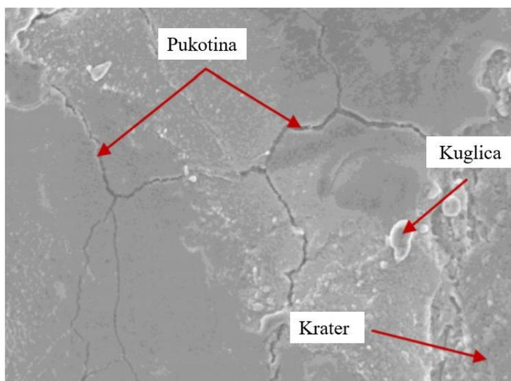
**Slika 60. Izgled obradene površine dobivene postupkom EDM-a [29]**
