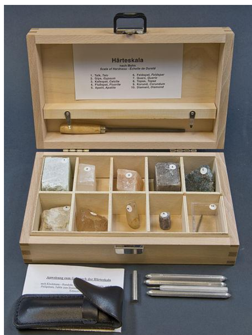
Slika 10. Oprema za ispitivanje tvrdoće po Mohs-u [7]
