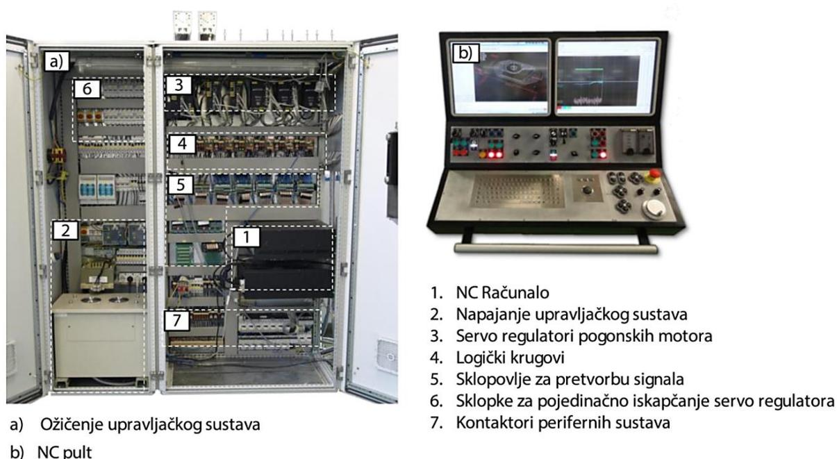
Slika 63. Elementi upravljačkog sustava eksperimentalnog postava [27]
