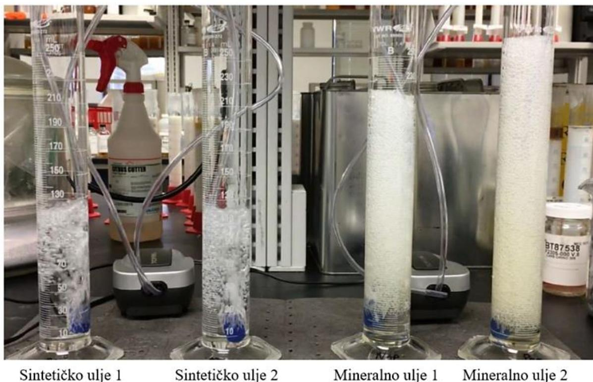
Slika 50. Pjenjenje kod mineralnih i sintetičkih ulja [21]
