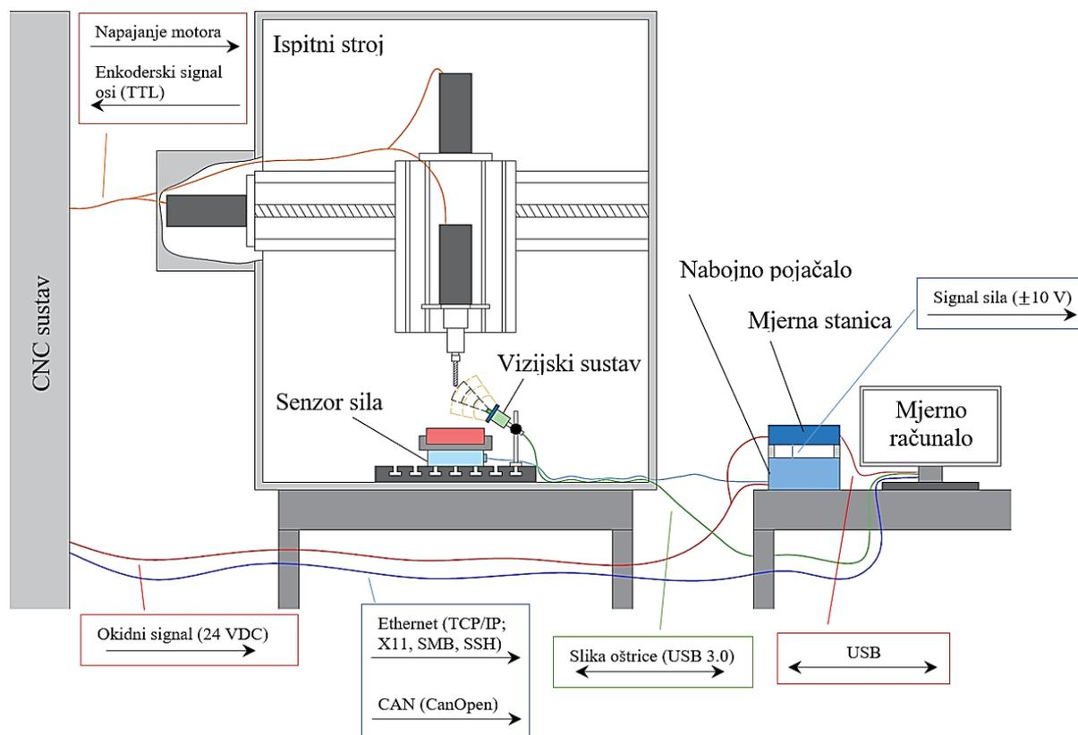
Slika 67. Shema kompletne strukture mjernog sustava
