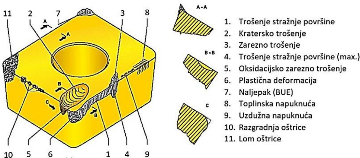
Slika 32. Uobičajeni položaji oblika trošenja reznih alata [2]
