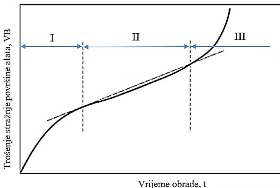
**Slika 44. Tipična krivulja trošenja reznih alata [3]**
