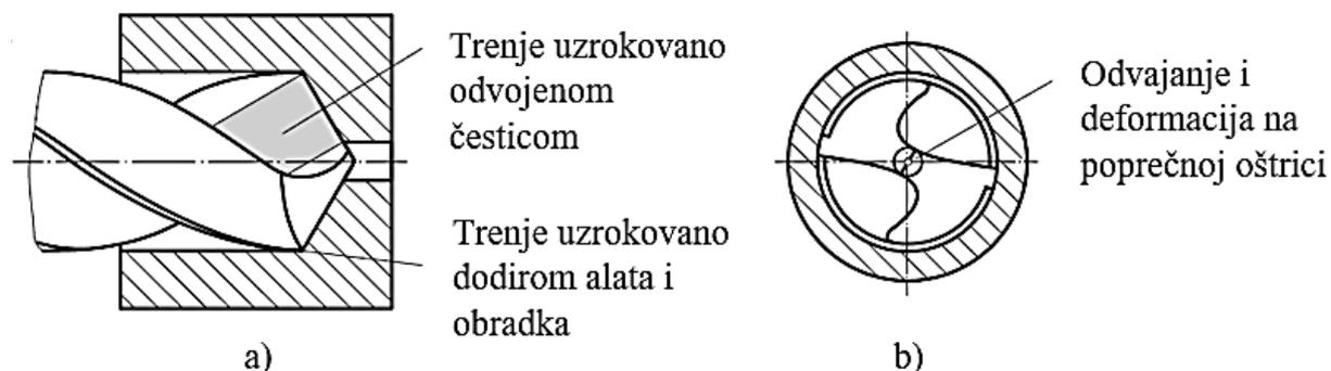
Slika 14. Proširivanje provrta i bušenje u puno [3]
