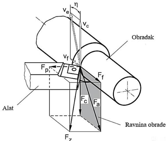
Slika 13. Sile rezanja kod tokarenja [3]
