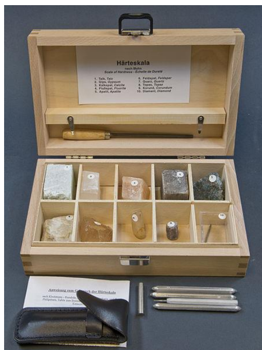
Slika 10. Oprema za ispitivanje tvrdoće po Mohs-u [7]
