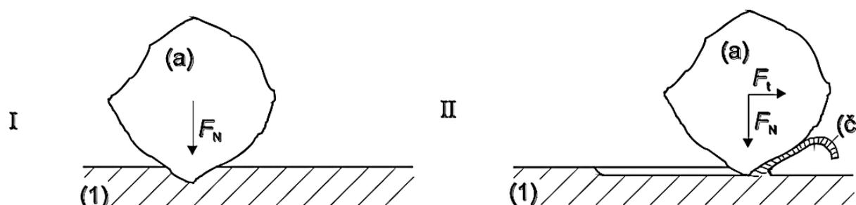
Slika 21. Abrazijsko trošenje [11]
