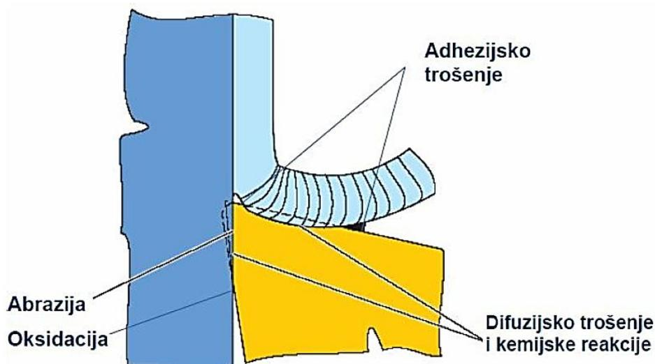
**Slika 20. Mehanizmi trošenja na alatu tijekom obrade [2]**
