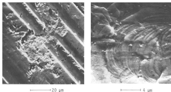
Slika 31. Izgled površine oštećene umorom površine [11]
