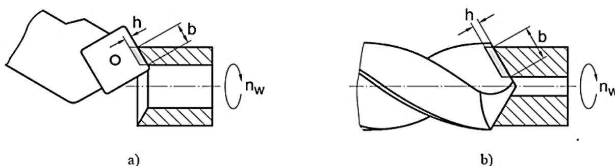
Slika 12. Fizikalni parametri kod tokarenja i bušenja [3]
