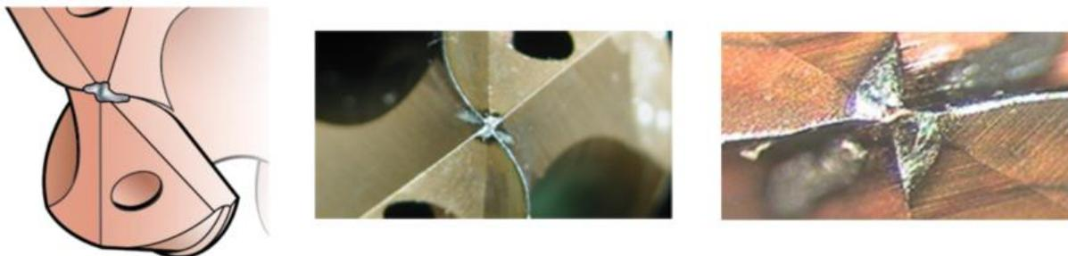
Slika 35. Trošenje stražnje površine poprečne oštrice [17]
