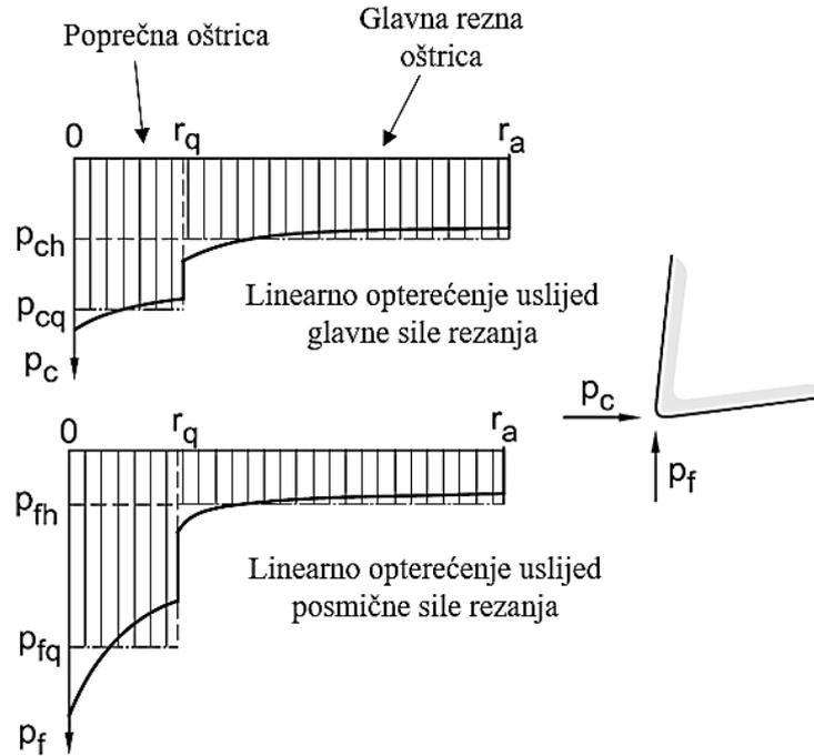
**Slika 16. Opterećenje na glavnoj reznj i poprečnoj oštrici [3]**
