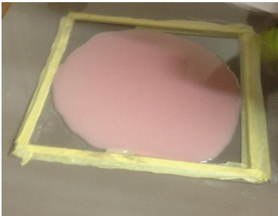
Slika 11. Ulijevanje PMMA u prvi kalup
