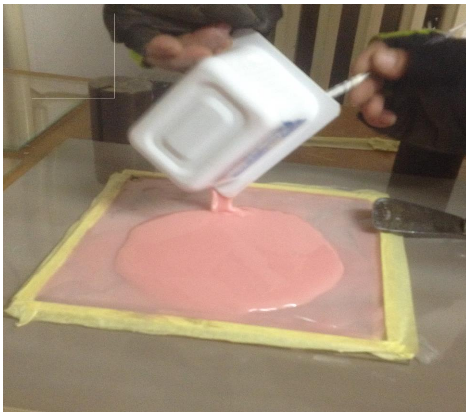
Slika 15. Ulijevanje ostatka materijala za ploču PMMA 2
