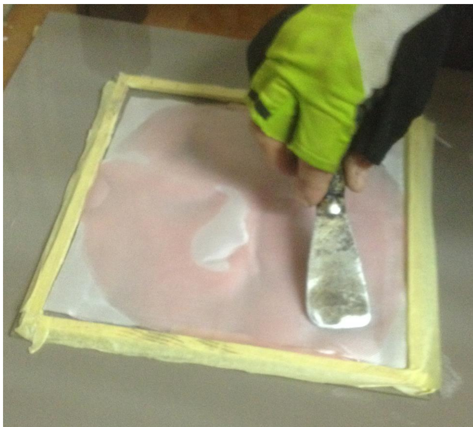
Slika 14. Zaglađivanje staklenih vlakana ploče PMMA 2
