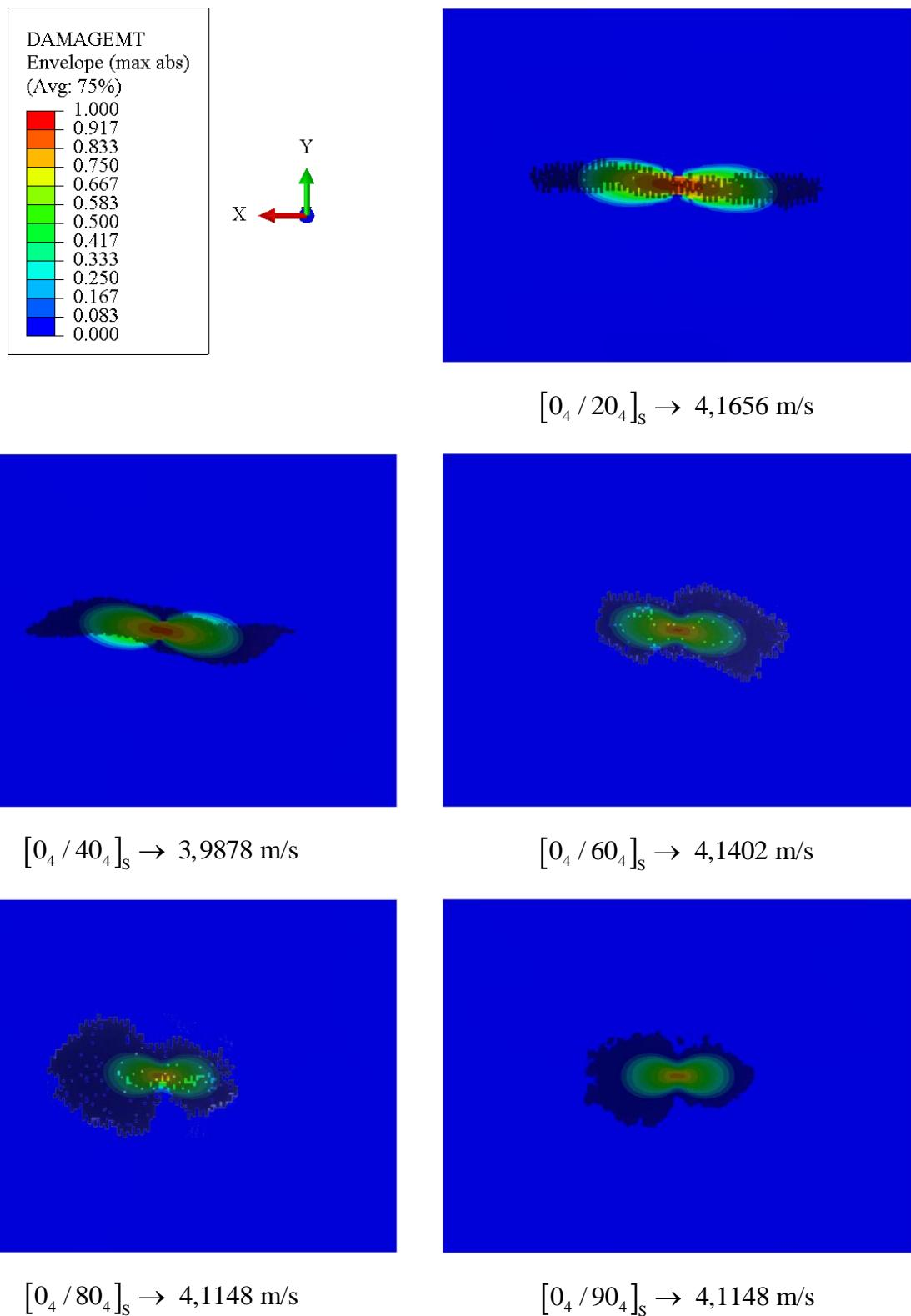
**Slika 43. Prikaz rezultata DAMAGE varijable za modele različitih postavnih kutova korištenjem Tie interakcije**
