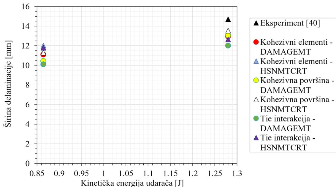
**Slika 28.** Dijagramske prikaze rezultata širiny delaminacije za modele  $[0_4 / 40_4]_S$  raspoređena pri različitim brzinama udara
