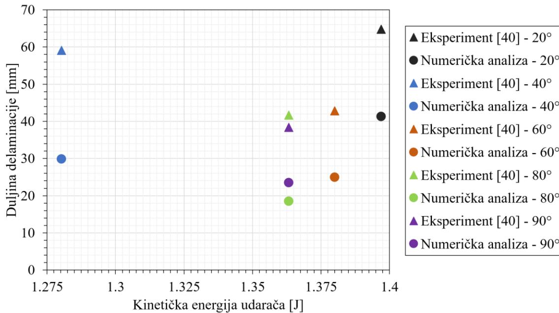
**Slika 50. Dijagramske prikaze rezultata duljine delaminacije HSNMTCRT varijable korištenjem površina kohezivnog ponašanja**
