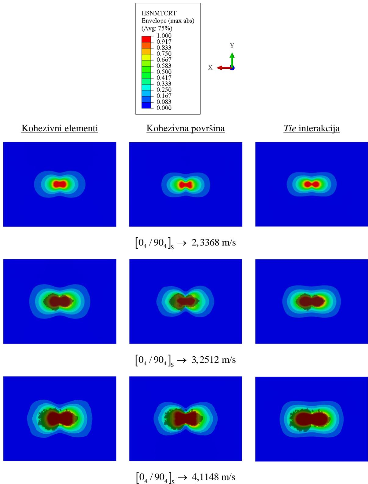
**Slika 18.** Prikaz rezultata HSNMTCRT varijable za modele *cross-ply* raspoređa pri različitim brzinama udara
