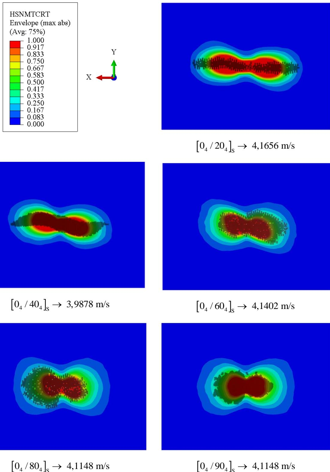
**Slika 46.** Prikaz rezultata HSNMTCRT varijable za modele različitih postavnih kutova korištenjem kohezivnih elemenata
