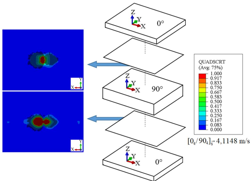
**Slika 31.** Rezultati varijable QUADSCRT za odgovarajuće plohe *zero-thickness* slojeva *cross-ply* modela
