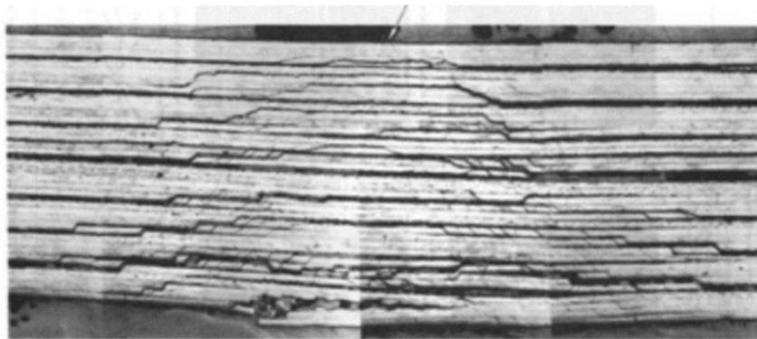
Slika 5. BVID oštećenja na CFRP kompozitnoj konstrukciji [25]
