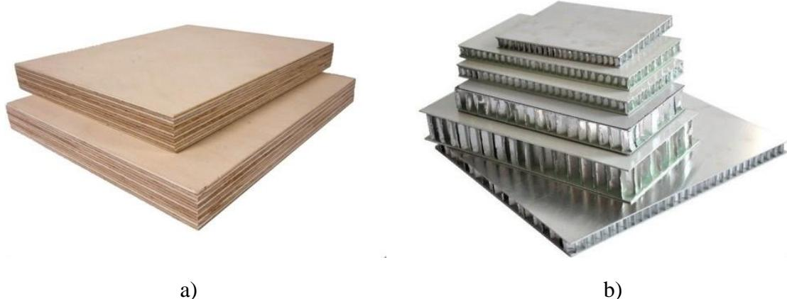
**Slika 2. Strukturni kompoziti: a) višeslojni kompozit – šperploča breze [9]; b) aluminijска sandwich struktura s jezgrom u obliku pčelinjih saća [10]**
