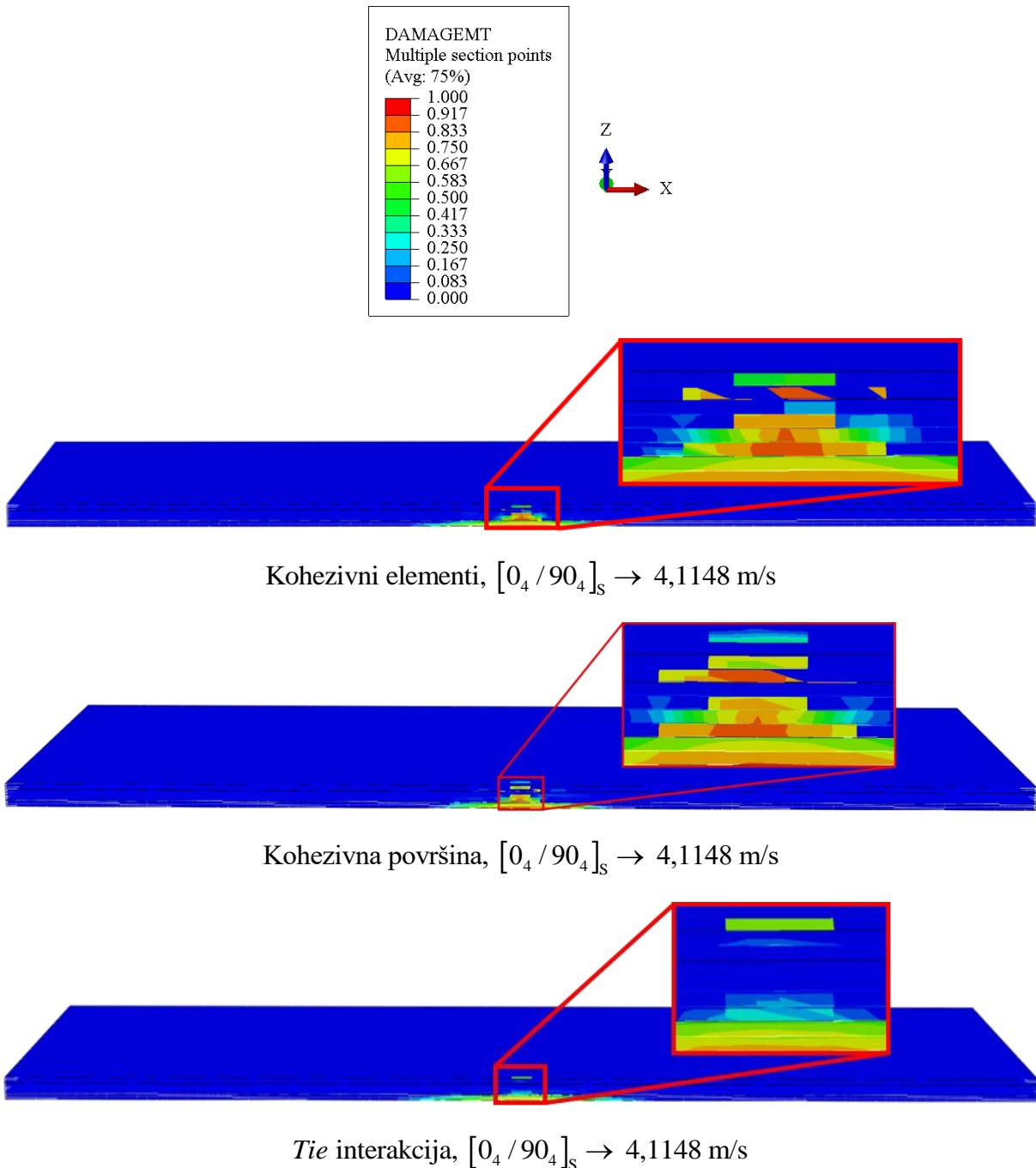
**Slika 23. Poprečni presjek triju *cross-ply* modela različitih korištenih mehanizama pri najvišoj brzini udarača za DAMAGEMT varijablu**
