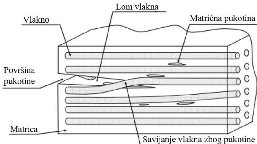
**Slika 4. Načini oštećenja kompozita s istosmjernim vlaknima [23,24]**
