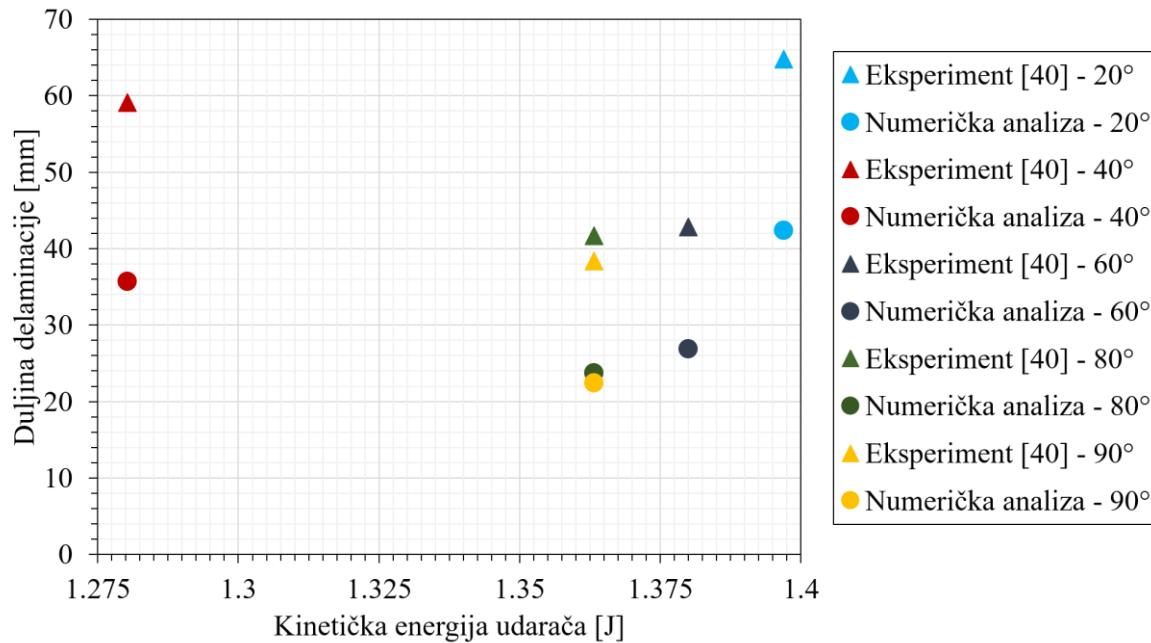
**Slika 47.** Dijagramske prikaze rezultata duljine delaminacije HSNMTCRT varijable korištenjem kohezivnih elemenata
