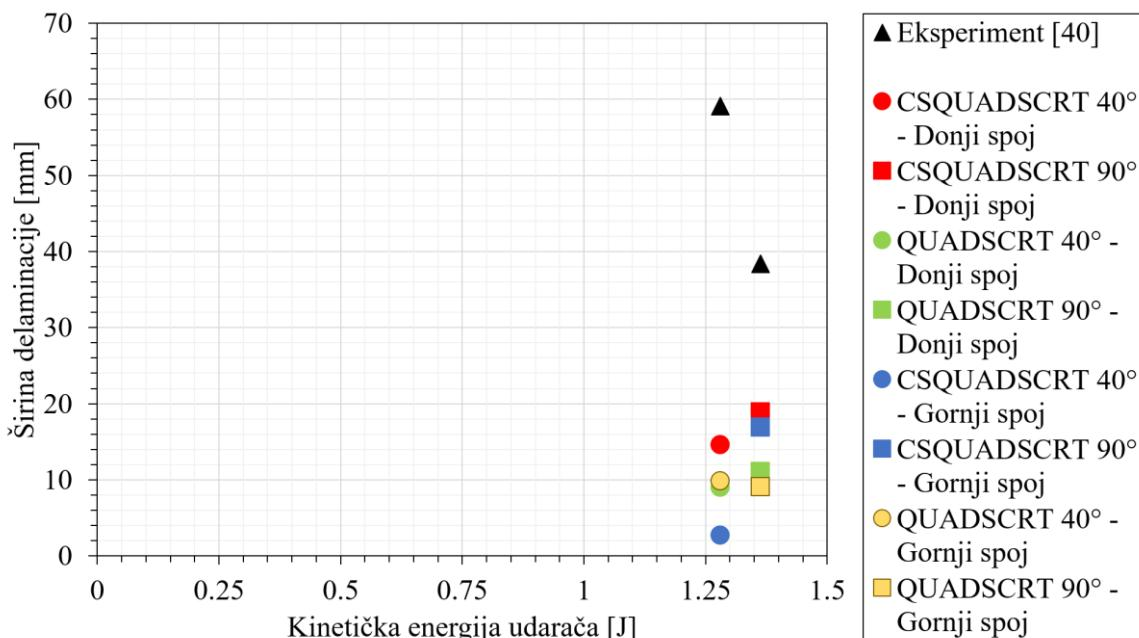
**Slika 36.** Dijagram širine delaminacije u ovisnosti o kinetičkoj energiji udarača za varijable kohezivnog ponašanja
