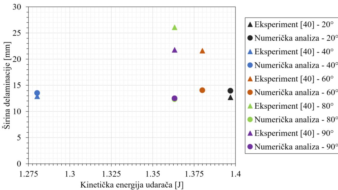
**Slika 51. Dijagramske prikaze rezultata širine delaminacije HSNMTCRT varijable korištenjem površina kohezivnog ponašanja**
