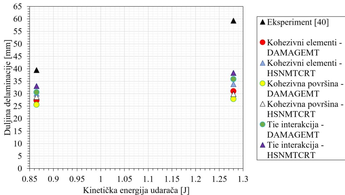
**Slika 27.** Dijagramske prikaze rezultata duljine delaminacije za modele  $[0_4 / 40_4]_S$  raspoređena pri različitim brzinama udara
