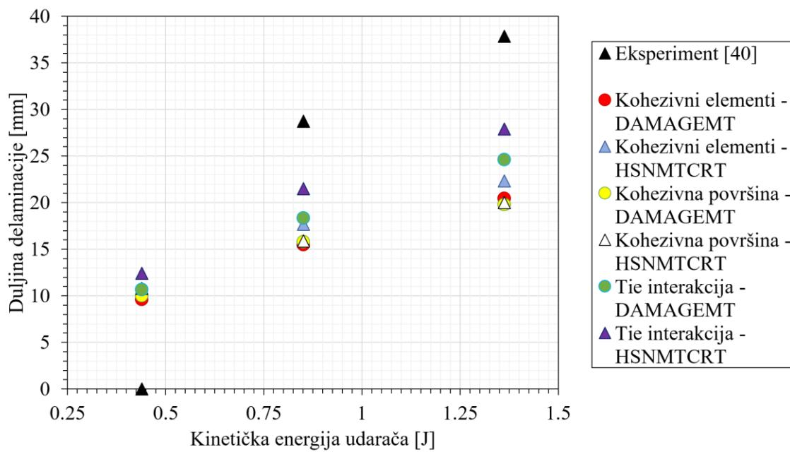
Slika 19. Dijagramske prikaze rezultata duljine delaminacije za modele *cross-ply* raspoređene pri različitim brzinama udara
