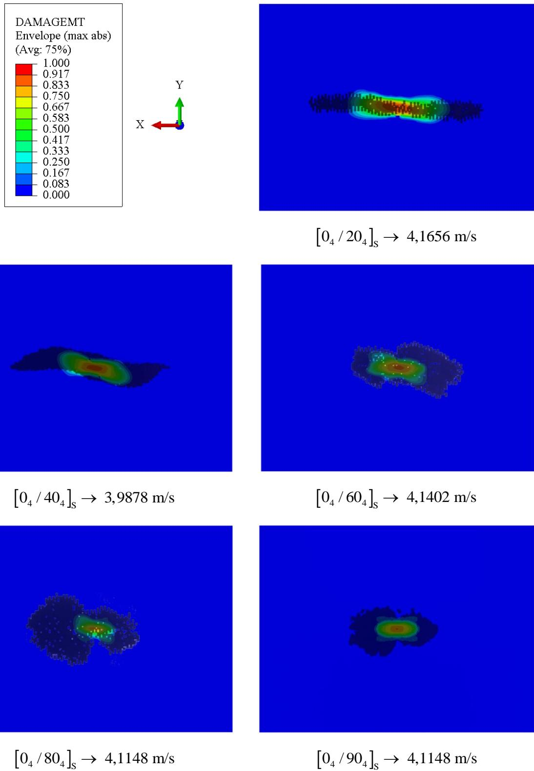
**Slika 40.** Prikaz rezultata DAMAGEMT varijable za modele različitih postavnih kutova korištenjem površina kohezivnog ponašanja
