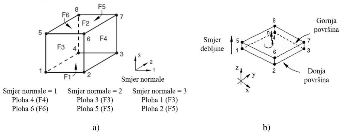
**Slika 9.** Trodimenzionalni heksaedarski kontinuumski ljsuskasti konačni element SC8R: a) smjerovi normala na plohe; b) smjer normale konačnog elementa [33]
