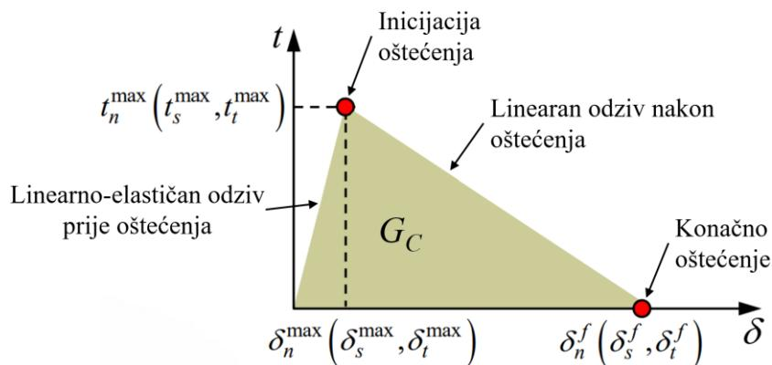
Slika 12. Zakon vlačnog naprezanja i odvajanja – linearno ponašanje [33]
