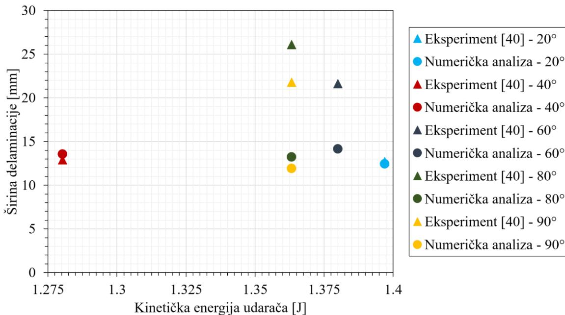
**Slika 48.** Dijagramske prikaze rezultata širine delaminacije HSNMTCRT varijable korištenjem kohezivnih elemenata
