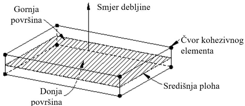
Slika 10. Prostorni prikaz trodimenzionalnog kohezivnog elementa [33]
