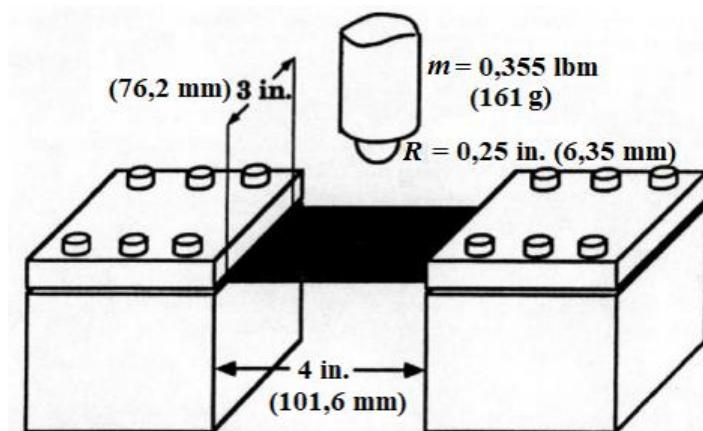
Slika 13. Prikaz modela za eksperimentalno ispitivanje udarnih opterećenja [40]
