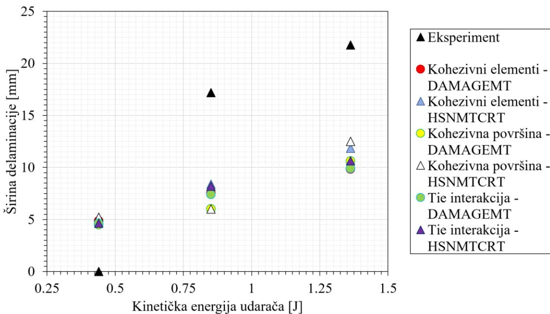
Slika 20. Dijagramske prikaze rezultata širine delaminacije za modele s *cross-ply* rasporedom pri različitim brzinama udara
