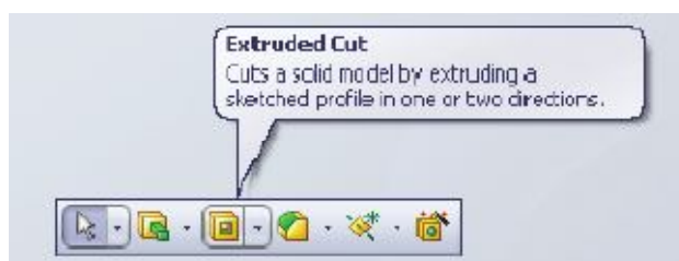
Slika 62. Funkcija Extruded Cut
