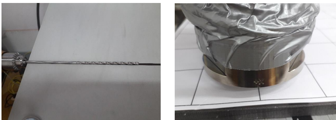
Slika 44. Kalibracija orijentacije koordirdinatnih sustava svrdla i senzora sile
