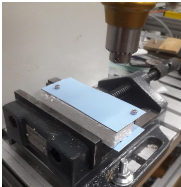
Slika 49. Nehomogena struktura (lim-eps-lim)
