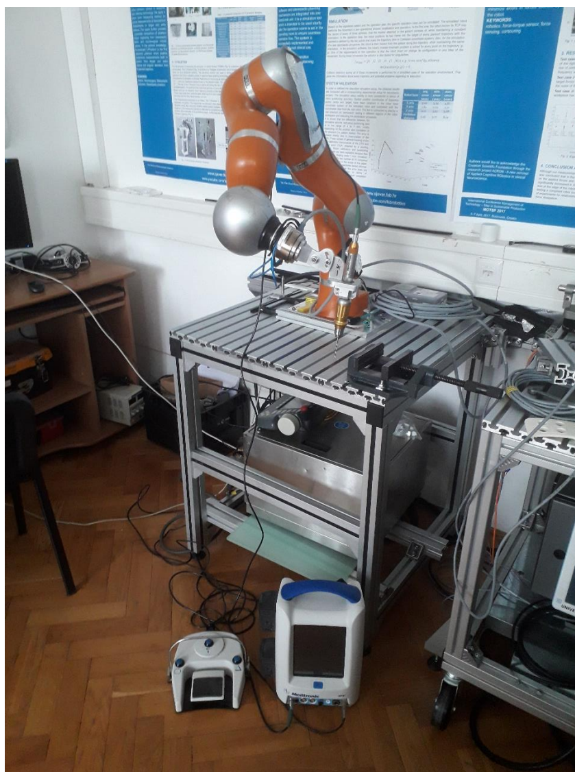
Slika 12. Laboratorijski postav za bušenje
