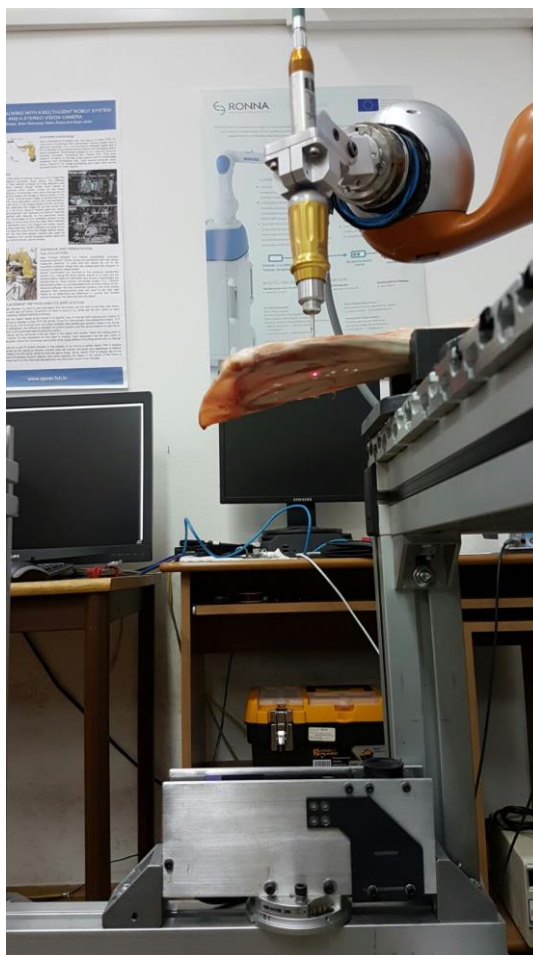
Slika 56. Kvantifikacija duljine hoda svrdla prilikom proboja
