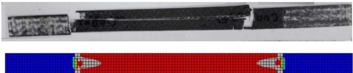
**Slika 7.6 Mehanizmi popuštanja u eksperimentu (gore) i numeričkoj simulaciji (dolje)**
