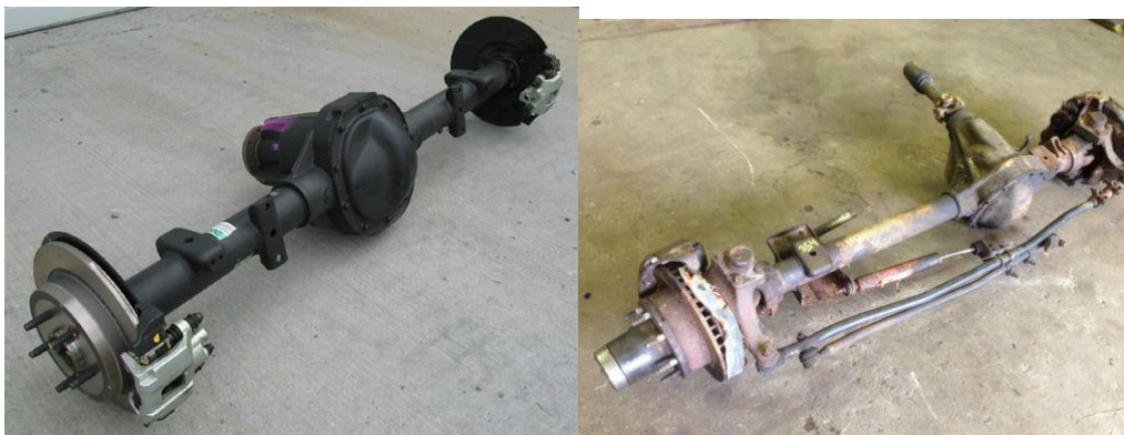
Slika 15. Stražnja [17] i prednja [18] pogonska kruta osovina
