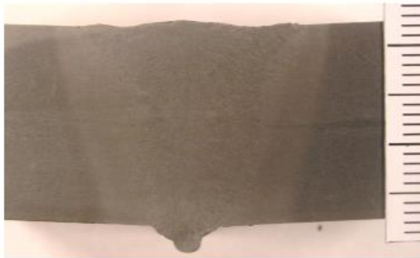
Slika 47. Makroizbrusak uzorka „B“ [29]
