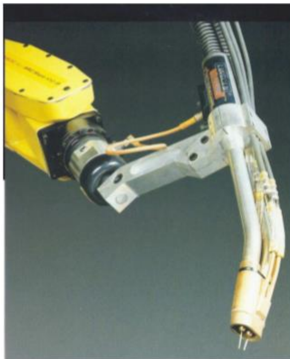
Slika 30. Pištolj za tandem postupak zavarivanja [13]
