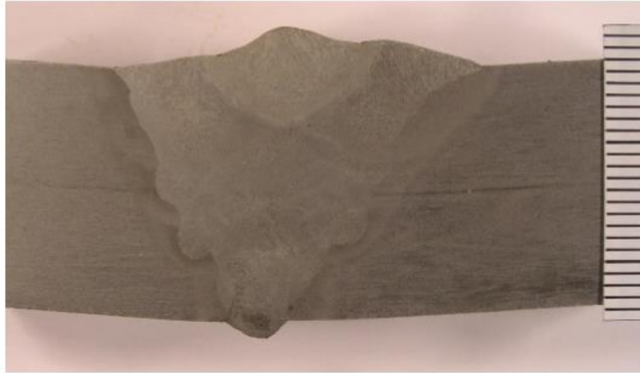
Slika 40. Makroizbrusak uzorka „A“ [30]
