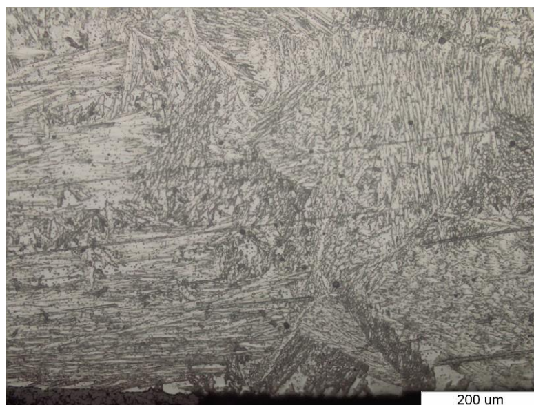
Slika 83. Mikrostruktura korijena zavara uzorka B, povećanje 200 x
