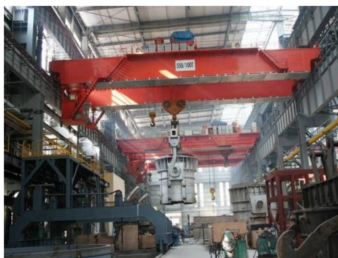
Slika 5. Mosni granik nosivosti 100 tona [6]
