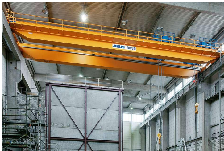
Slika 4. Mosni granik nosivosti 60 tona [5]
