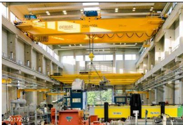
Slika 7. Mosni granik nosivosti 200 tona [8]
