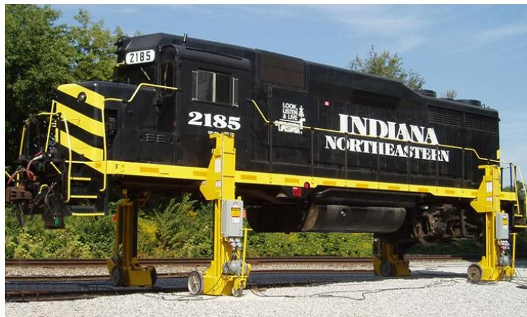
Slika 1. Podizanje lokomotive s četiri mobilne električne dizalice [1]
