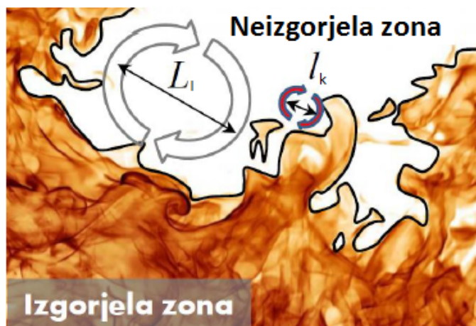
Slika 13. Podjela mješavine u cilindru na izgorjelu i neizgorjelu zonu [10]
