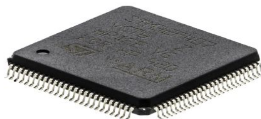
Slika 38. Mikrokontroler STM32F407VGT6 proizvođača STMicroelectronics
