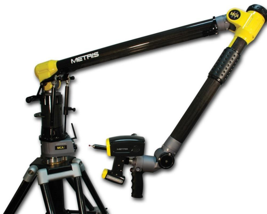
Slika 3. Prijenosni koordinatni mjerni uređaj
