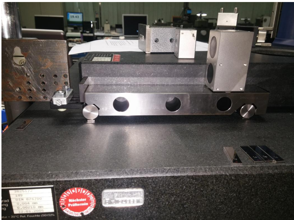
Slika 28. Postavljanje mjerki i sinus lineala
