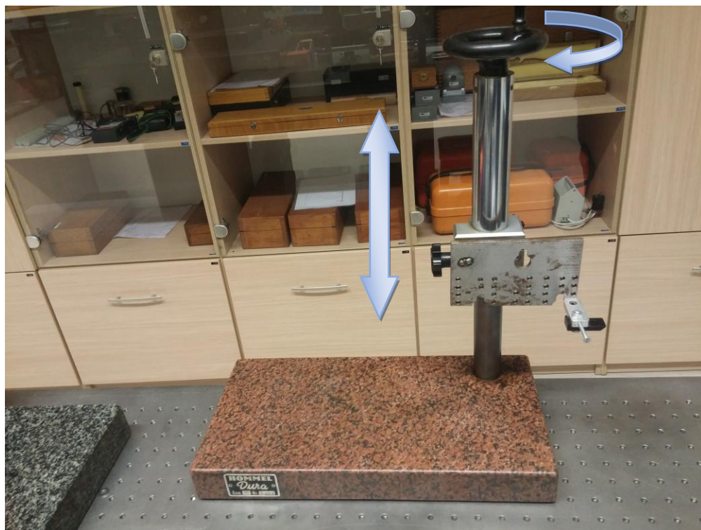
Slika 27. Uređaj za izmjenu planparalelnih graničnih mjerki
