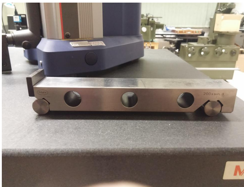
Slika 17. Sinus lineal 200 \times \sin \alpha
