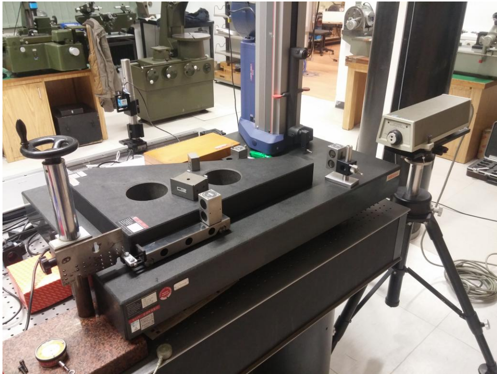
Slika 29. Postavljeni laserski mjerni sustav
