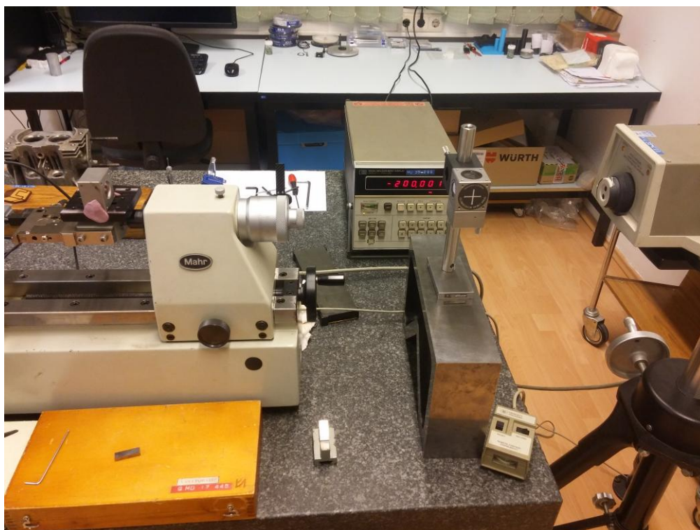
Slika 19. Laserski mjerni sustav HP 5528A
