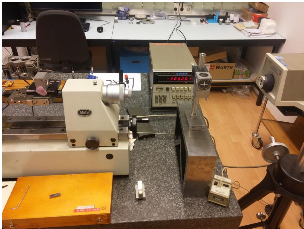
Slika 19. Laserski mjerni sustav HP 5528A
