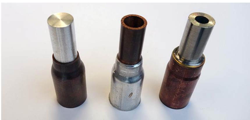
Slika 9. Elektromagnetski spojeni cjevasti profili Al-Cu[18]
