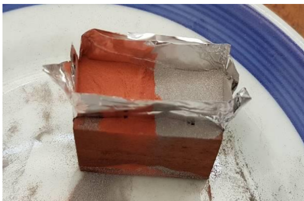
Slika 26. Sipanje praha u kalup
