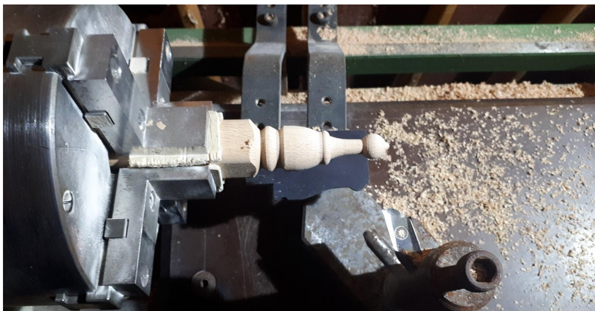
Slika 23. Izrada figura preslikavanjem siluete
