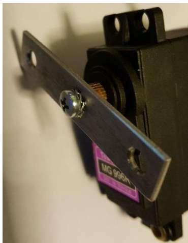
Slika 17. Spoj nastavka i vratila servomotora
