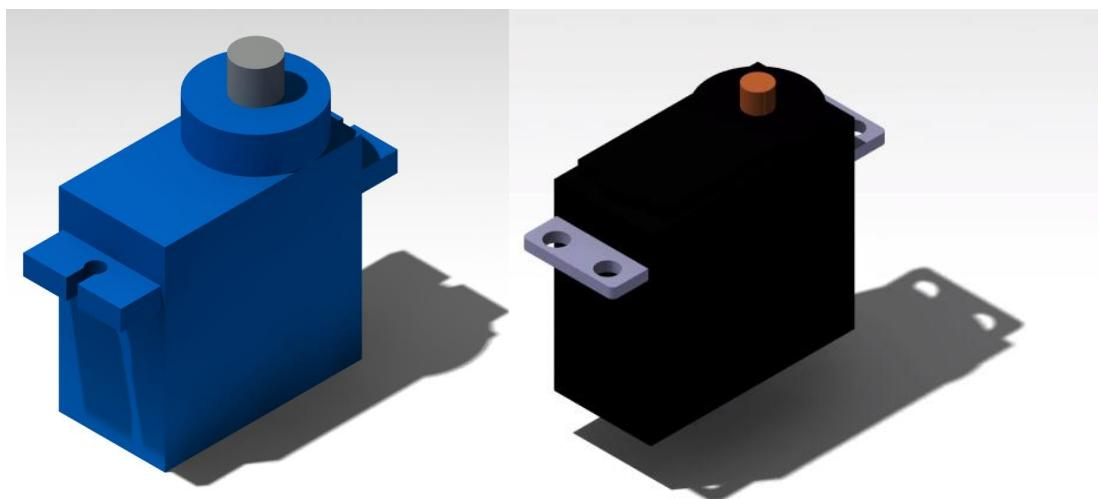
Slika 11. 3D modeli motora SG90(lijevo) i MG996R(desno)
