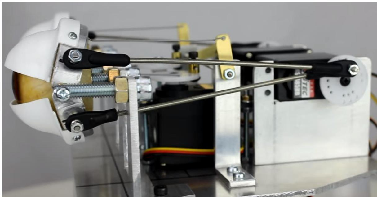
Slika 9. Animatronički mehanizam za pokretanje očiju s 4 motora[7]
