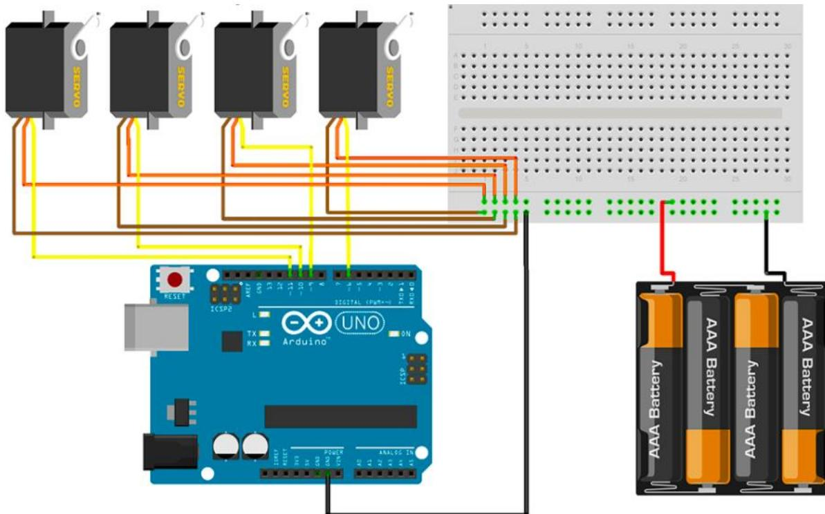
Slika 28. Shema spajanja motora[11]
