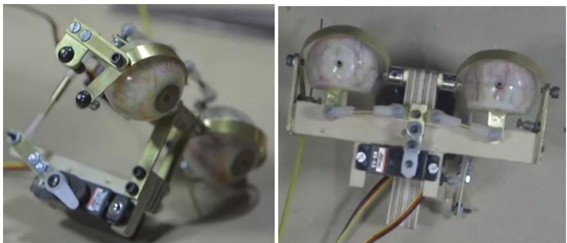
Slika 10. Animatronički mehanizam za pokretanje očiju s 2 motora[8]
