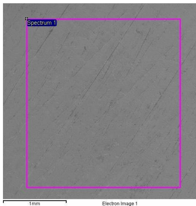
Slika 40. Mjesto ispitivanja kemijskog sastava pomoću EDS-detektora
