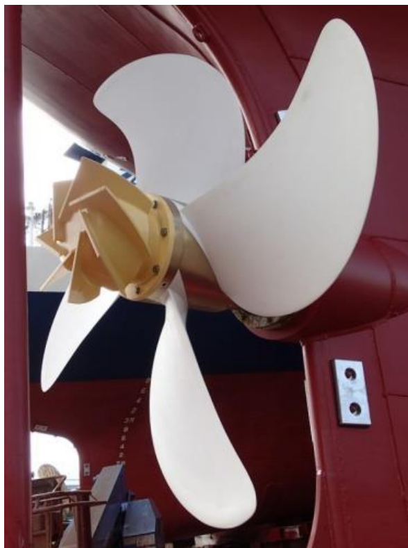
Slika 21. Vlanknima ojačani polimerni kompozitni brodski vijak [18]
