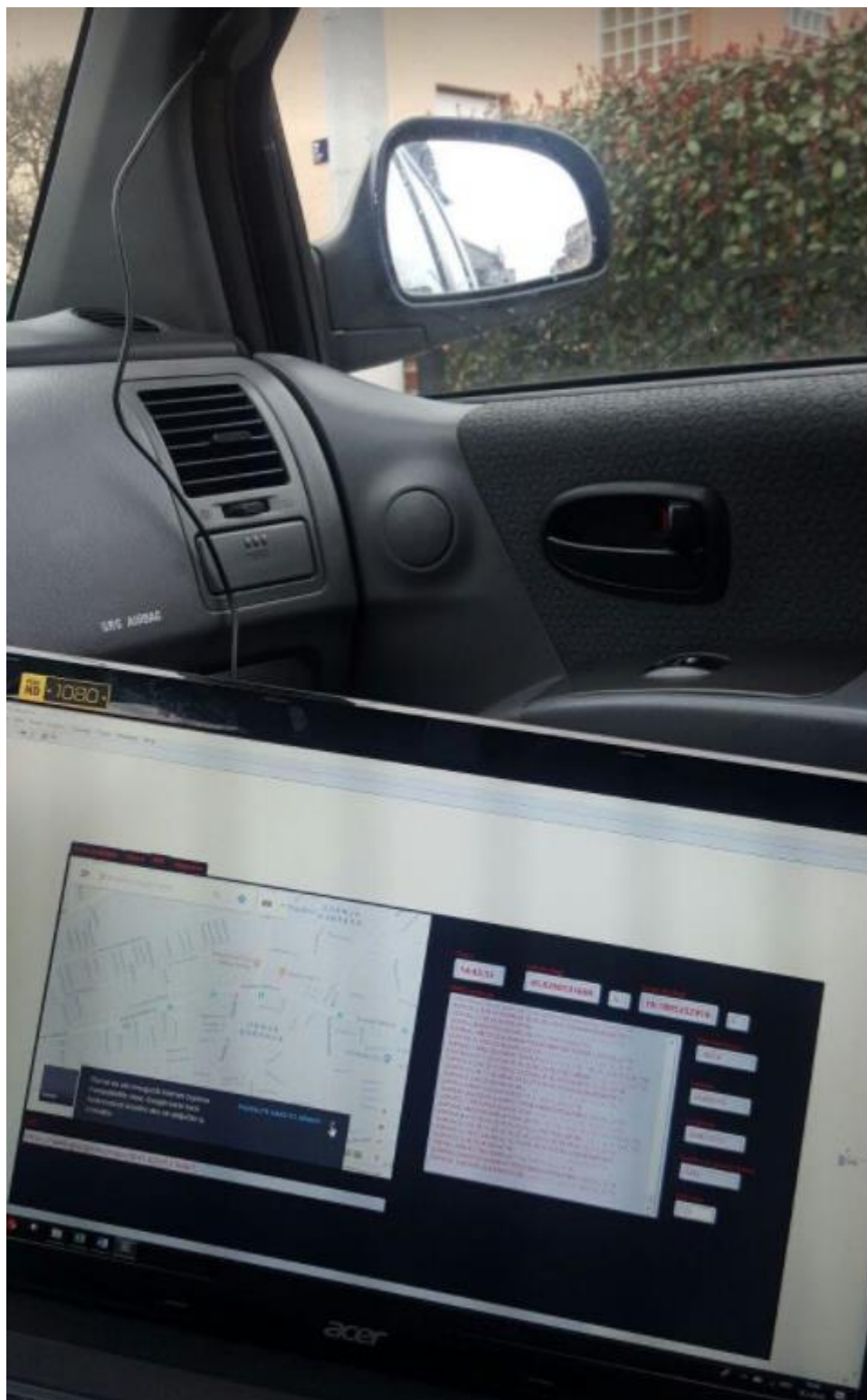
Slika 33. Povezivanje GPS antene sa programskim sučeljem
