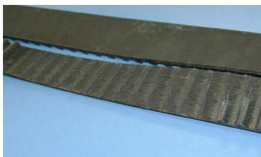
Slika 28. Odrez zuba zupčastog remena [8]
