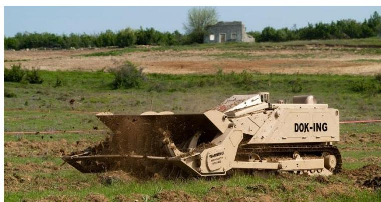
Slika 3. Razminiranje strojem (DOK-ING MV-4) [18]
