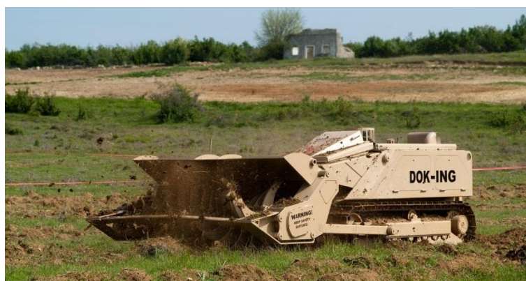
Slika 3. Razminiranje strojem (DOK-ING MV-4) [18]
