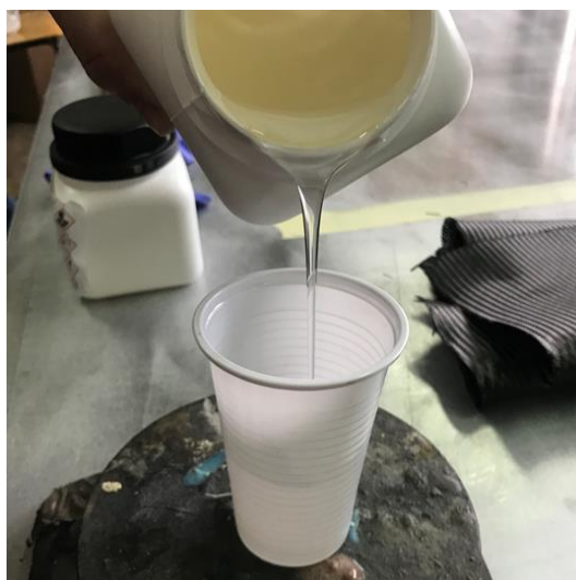
Slika 41. Miješanje smole i otvrdnjivača
