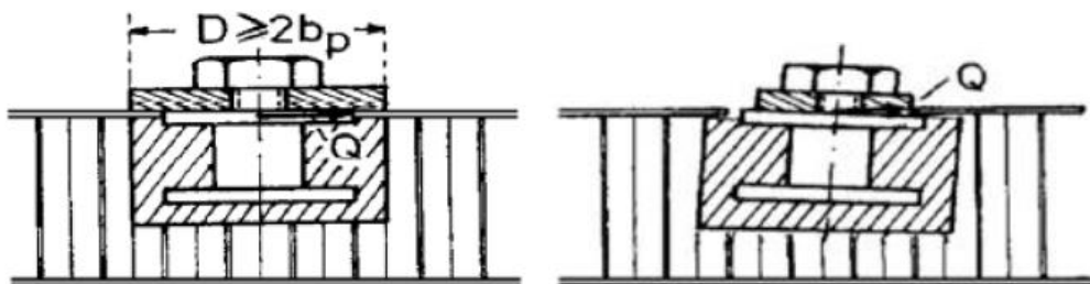
Slika 25. Umetci opterećeni vertikalnim silama
