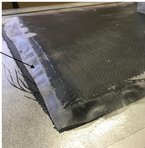
Slika 46. Postavljanje tkanine za odjeljivanje
