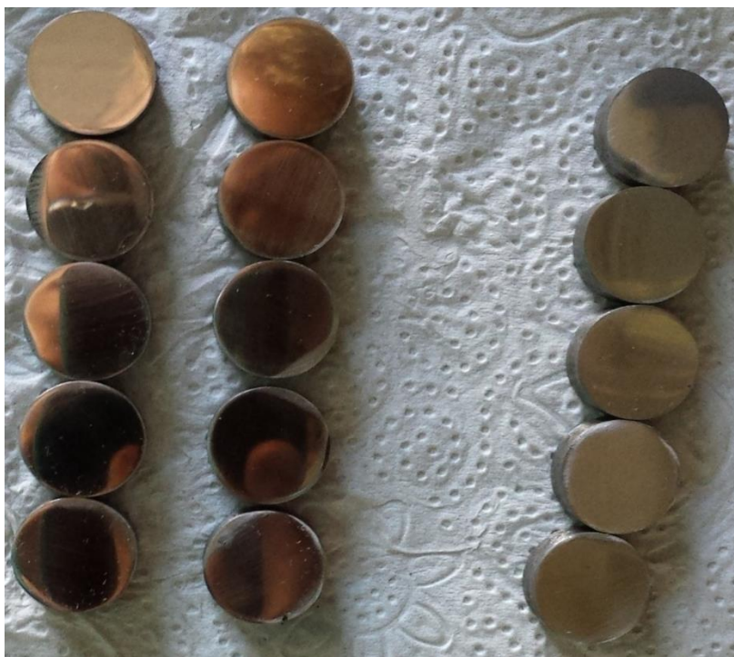
Slika 13. Fino brušeni ispitni uzorci i grubo brušeni ispitni uzorci
