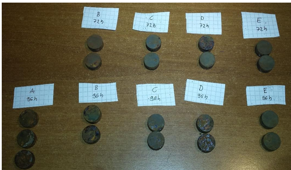
Slika 18. Ispitni uzorci nakon ispitivanja korozijske postojanosti
