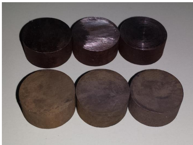
Slika 9. Strojno brušeni ispitni uzorci i ispitni uzorci nakon kemijskog čišćenja
