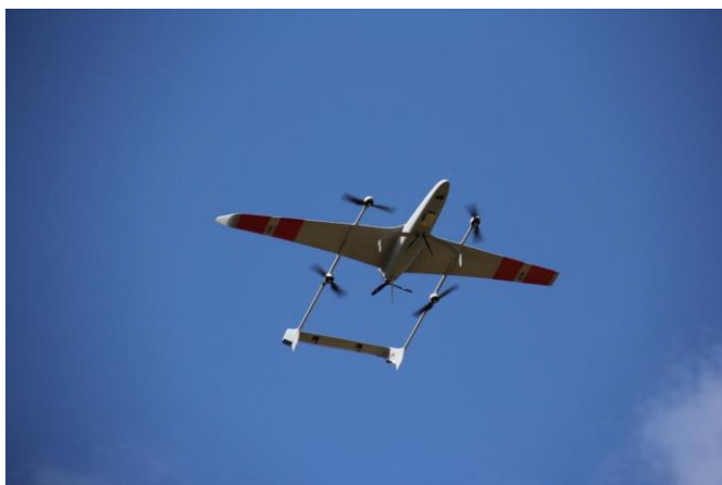
Slika 11. Carbonix Volanti, hibridni quadcopter
