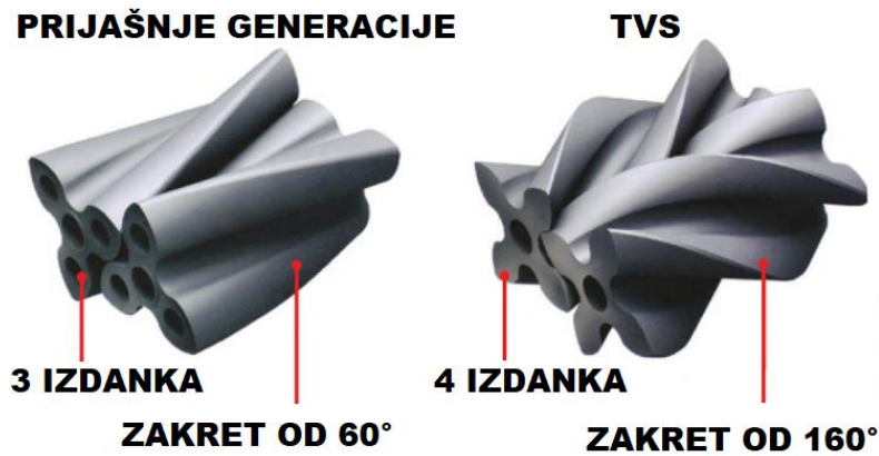
Slika 19. Usporedba rotora vijčanog kompresora [19]
