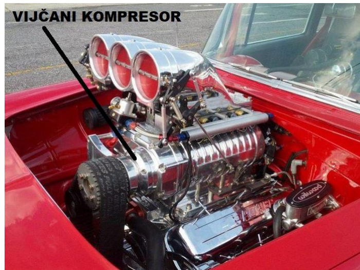
Slika 21. Uporaba vijčanog mehanički pogonjenog kompresora na trkaćem automobilu [17]
