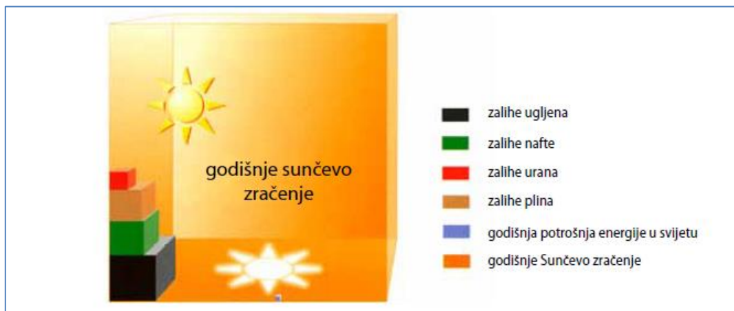
Slika 19 Godišnje sunčevo zračenje na površini Zemlje u usporedbi sa zalihama fosilnih nuklearnih goriva te godišnjom potrošnjom energije u svijetu
