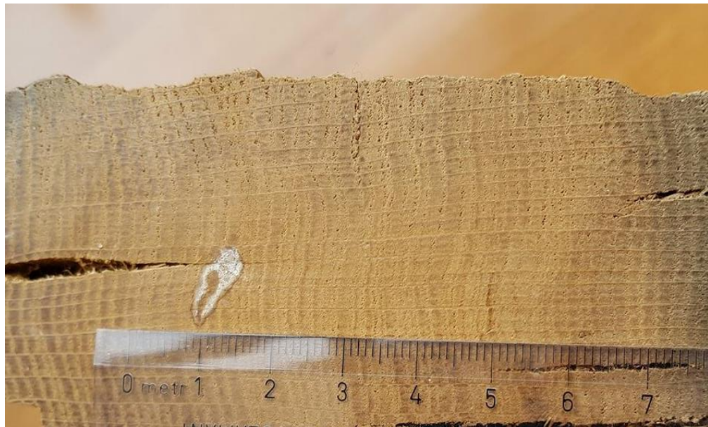
Slika 23. Makrostruktura poprečnog presjeka subfosilnog hrasta (uzorak 2)
