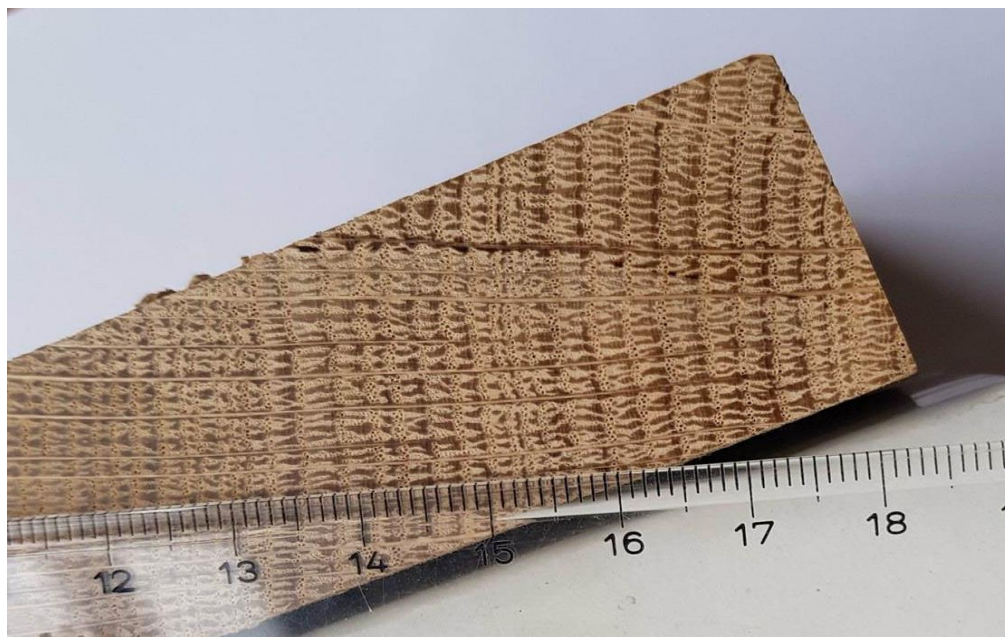
Slika 21. Makrostruktura poprečnog presjeka recentnog hrasta (uzorak 0)
