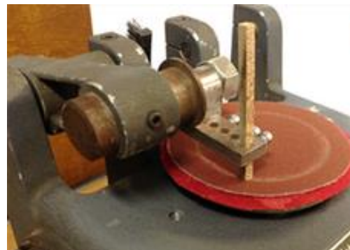
Slika 27. Prikaz abrazijskog trošenja na Taber abraderu
