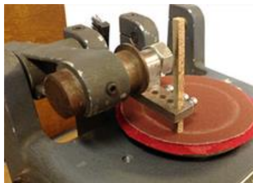
Slika 27. Prikaz abrazijskog trošenja na Taber abraderu
