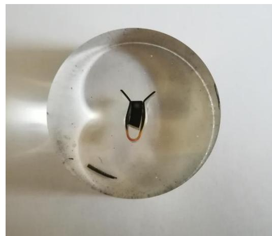
Slika 6. 7. Svjetlosni mikroskop Olympus GX51 i uzorak zaliven u polimernu masu
