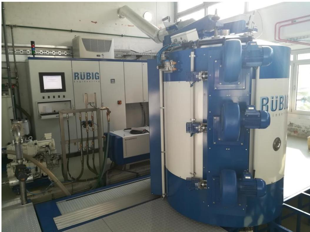
Slika 3. 11. PACVD uređaj Rubig 70/90 instaliran na FSB-u
