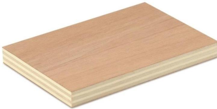
Slika 5. Šperploča - primjer strukturnog kompozita [5]
