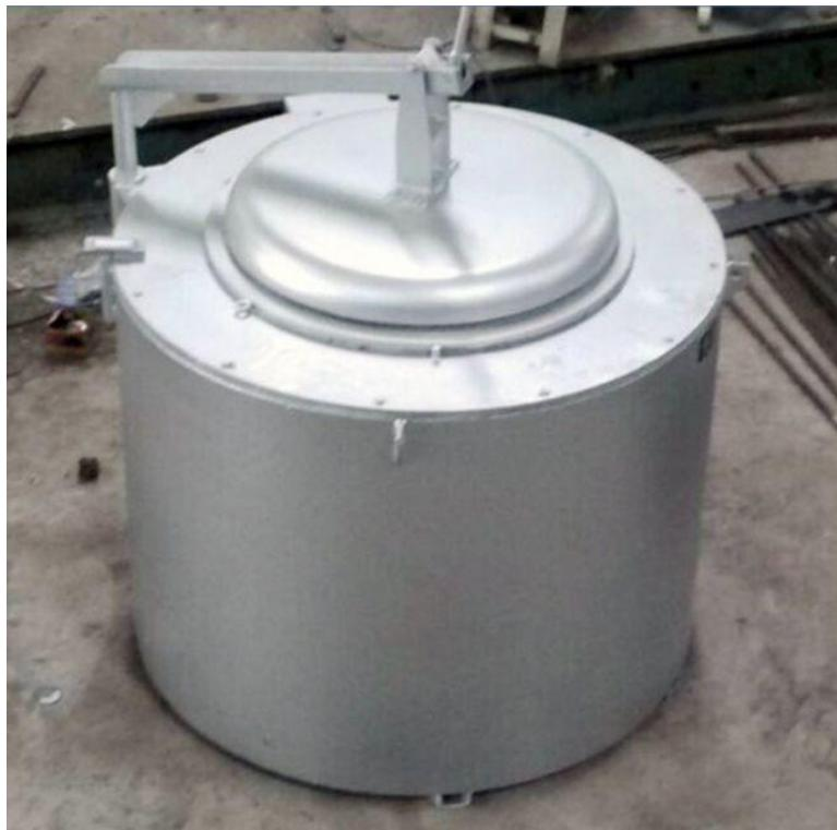
Slika 22. Elektrootporna peć za taljenje metala [27]
