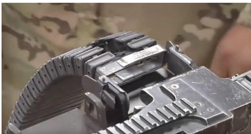
Slika 22 Ulazni otvor na strojnici M249
