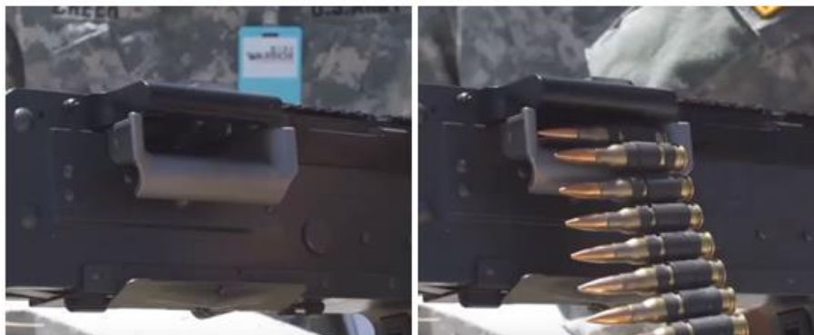
Slika 20. Ulazni otvor na uvodniku metaka strojnice M240
