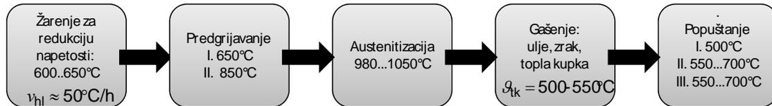
Slika 2.10. Blok dijagram tijekom toplinske obradbe čelika X38 CrMoV 5 1 [3]
