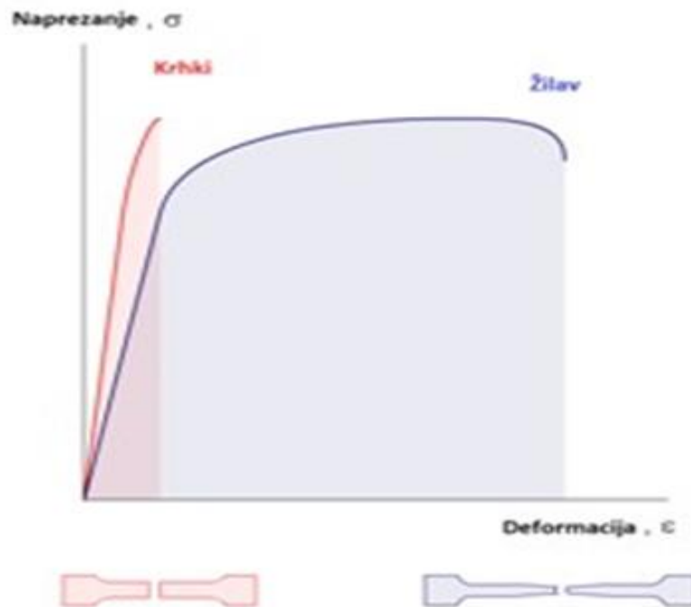
Slika 2. Dijagram naprezanja za žilavi i krhki materijal [2]
