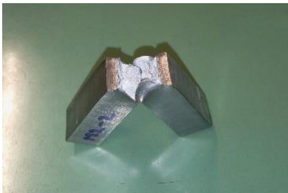
Slika 26. Prikaz žilavog loma na epruvete M2-2
