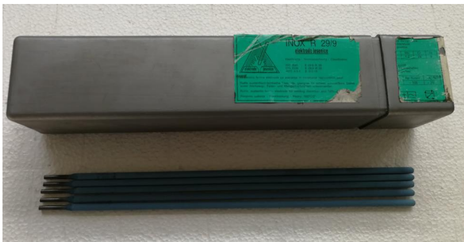
Slika 37. Elektroda R 29/9 prije bojanja
