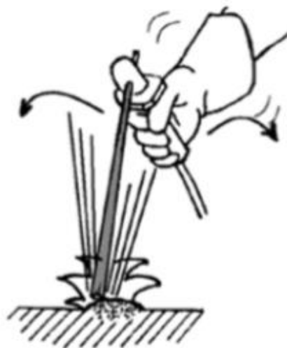
Slika 18. Zavarivanje tehnikom njihanja elektrode [14]
