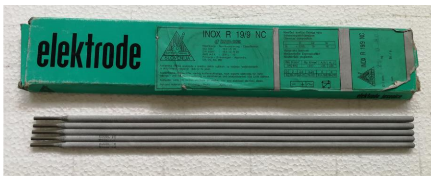
Slika 36. Elektroda R 19/9 prije bojanja
