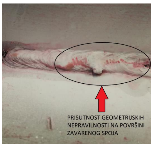
Slika 54. Rezultati penetracijske analize na zavaru 1
