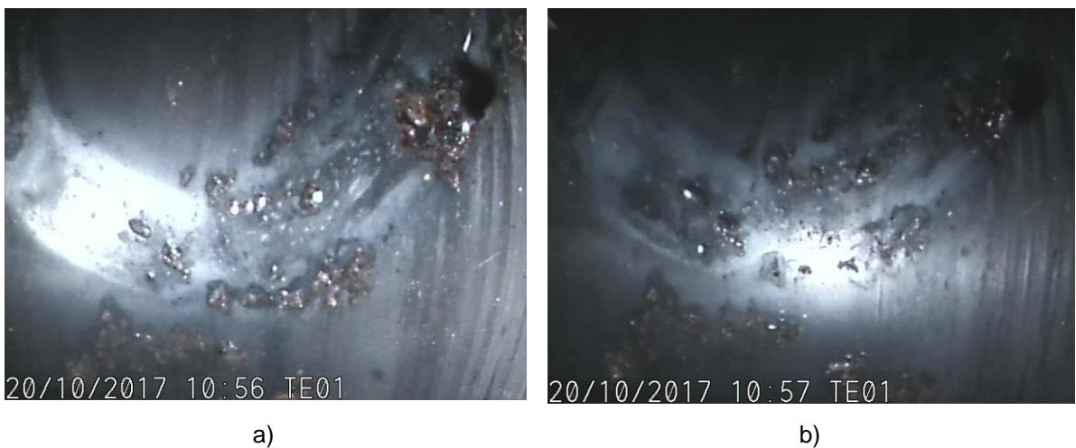
**Slika 15. Segment šasije FIREWALL: stanje unutrašnje površine cijevi na mjestu zavara**
