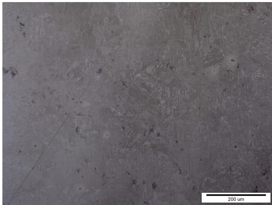
Slika 69. Segment šasije PODNICA uzorak 5: mikrostruktura materijala ZAVAR
