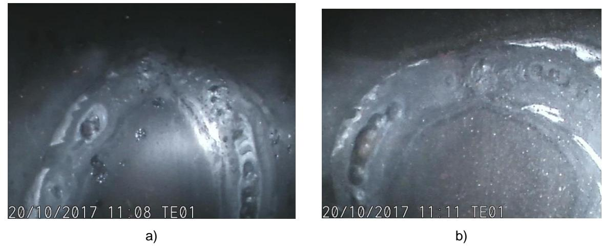
**Slika 48. Segment šasije PODNICA: stanje unutrašnje površine cijevu, detalji zavara**
