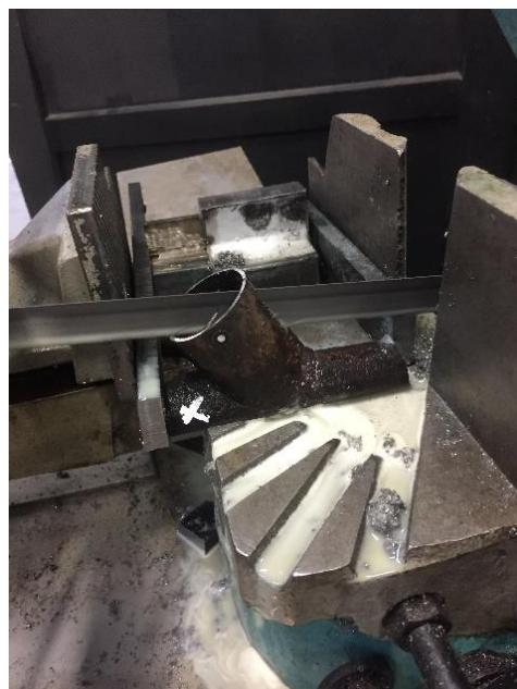
Slika 3. Izrezivanje uzorka tračnom pilom
