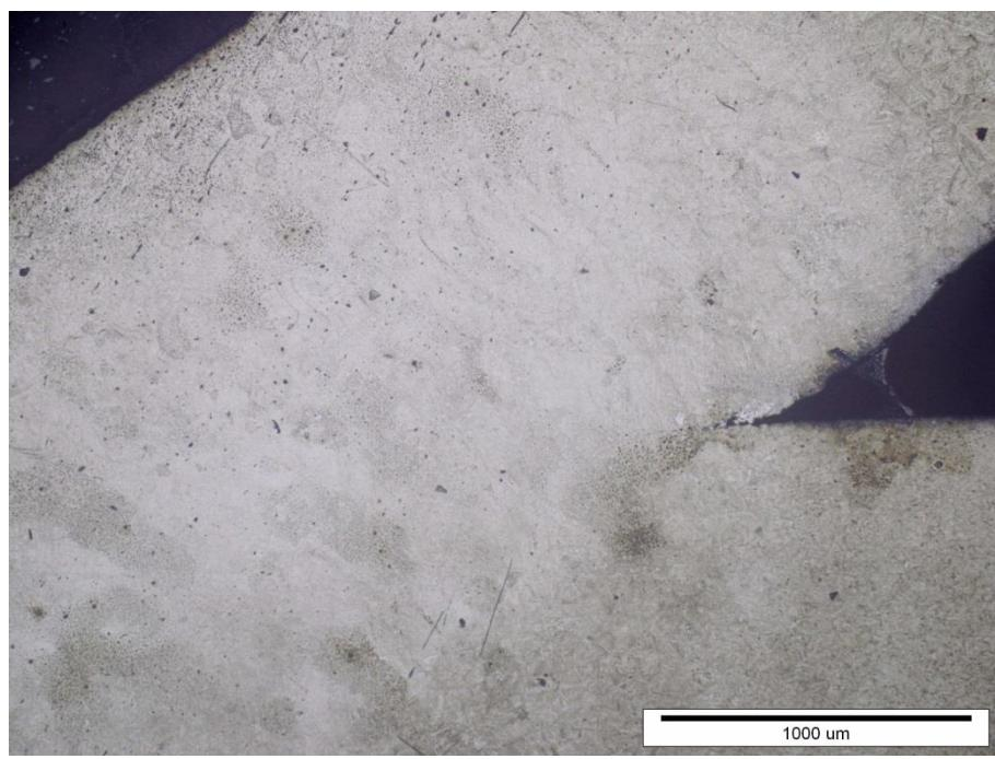
Slika 75. Segment šasije PODNICA uzorak 6: mikrostruktura na poziciji ZAVAR
