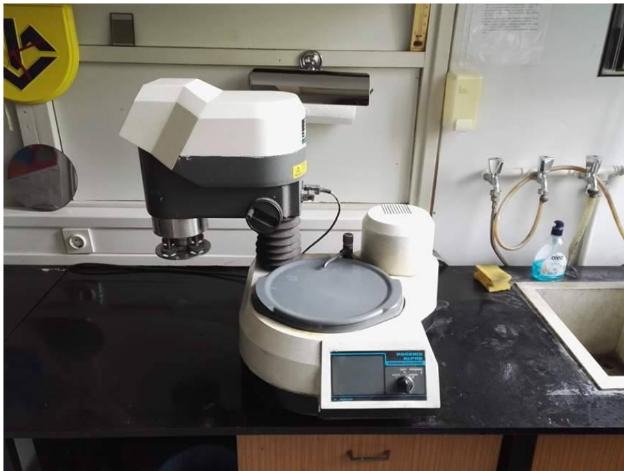
Slika 5. Uređaj za brušenje uzoraka [6].
