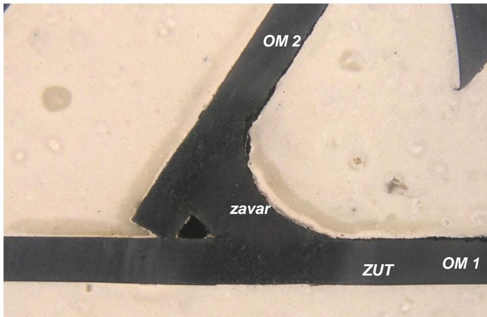
**Slika 21. Segment šasije FIREWALL uzorak 1: makrostruktura s mjestima analize mikrostrukture**
