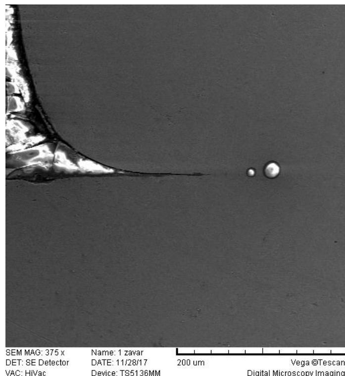
**Slika 60. Segment šasije PODNICA uzorak 4: nerastaljeni materijal, porozitet, SEM**
