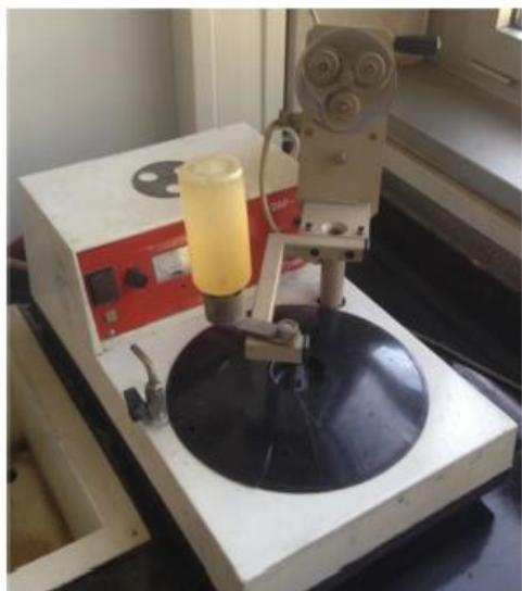
Slika 6. Uređaj za poliranje uzorka [6].
