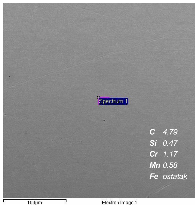
Slika 29. Segment šasije FIREWALL uzorak 1: mjesto i rezultati EDS analize, OM1
