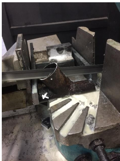
Slika 3. Izrezivanje uzorka tračnom pilom
