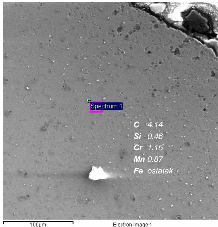
**Slika 72. Segment šasije PODNICA uzorak 5: mjesto i rezultati EDS analize, materijal zavara**
