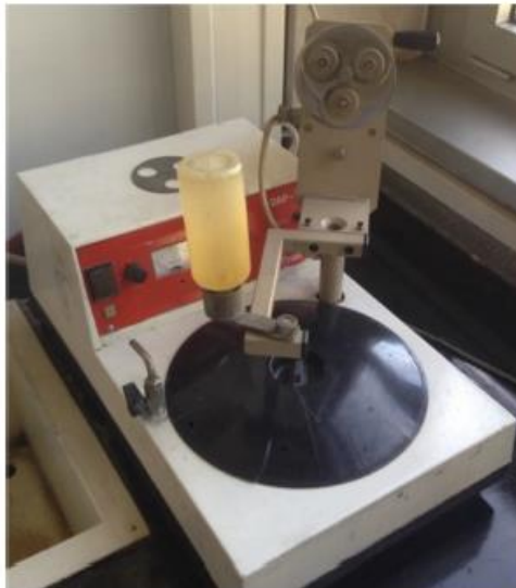
Slika 6. Uređaj za poliranje uzoraka [6].
