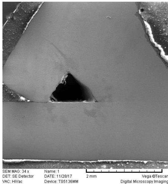
Slika 27. Segment šasije FIREWALL uzorak 1: zavar, SEM, neprotaljenost
