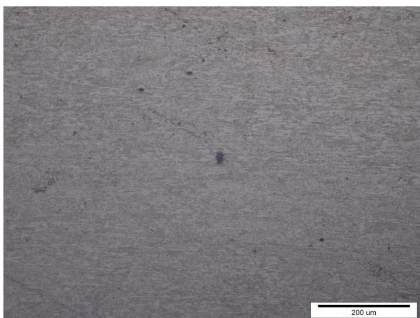
**Slika 22. Segment šasije FIREWALL uzorak 1: mikrostruktura osnovnog materijala na poziciji OM1, usmjerenja feritno-perlitna mikrostruktura**
