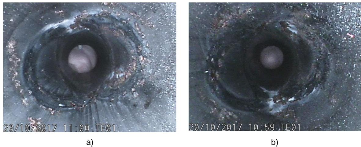
**Slika 47. Segment šasije PODNICA: stanje unutrašnje površine cijevi, mjesto zavara**
