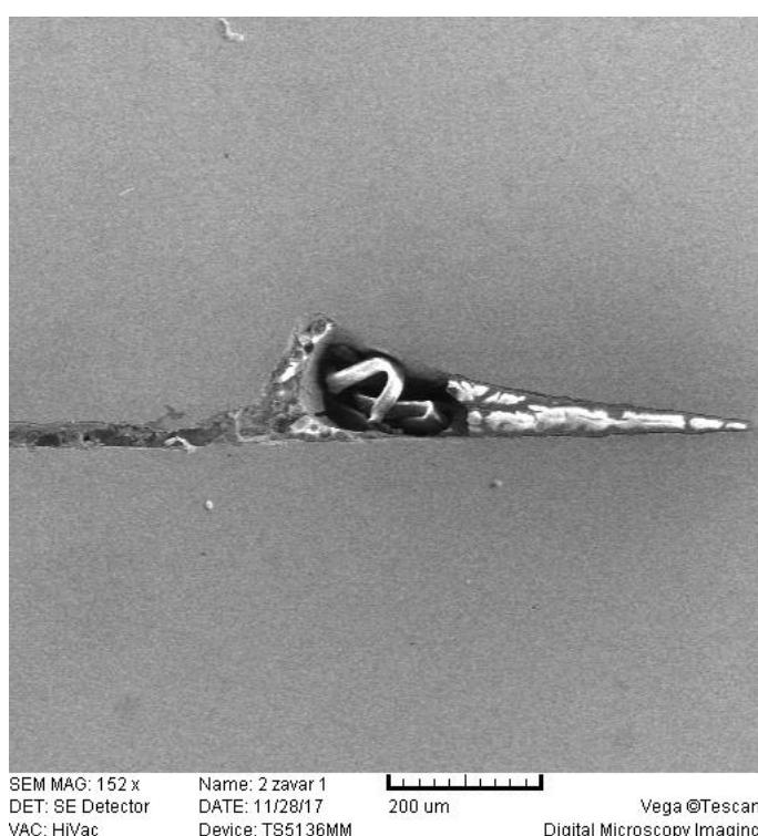
Slika 71. Segment šasije PODNICA uzorak 5: detalj zavara, SEM
