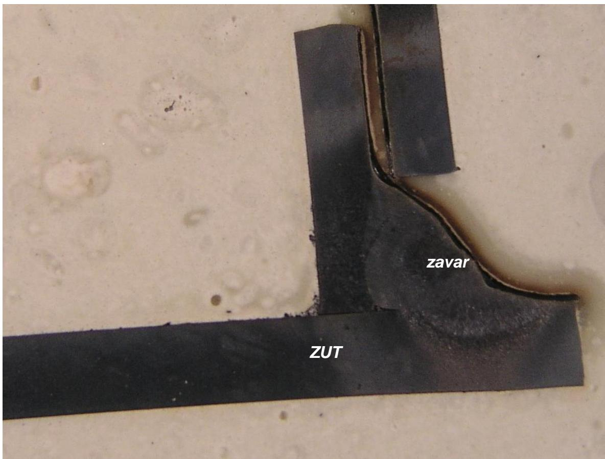
**Slika 65. Segment šasije PODNICA uzorak 5: makrostruktura s mjestima analize mikrostrukture**
