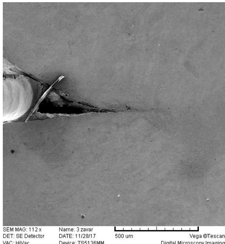
**Slika 77. Segment šasije PODNICA uzorak 6: zavar, SEM, neprotaljenost**
