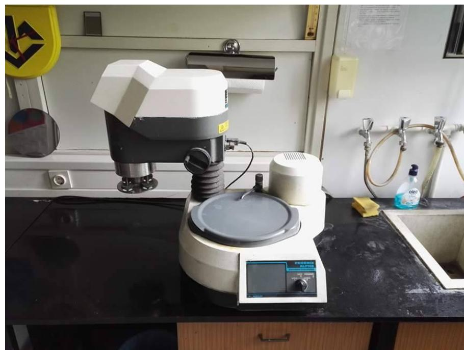
Slika 5. Uređaj za brušenje uzoraka [6].
