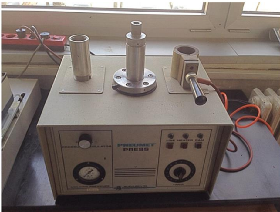
Slika 4. Uređaj za ulijevanje uzorka [6].
