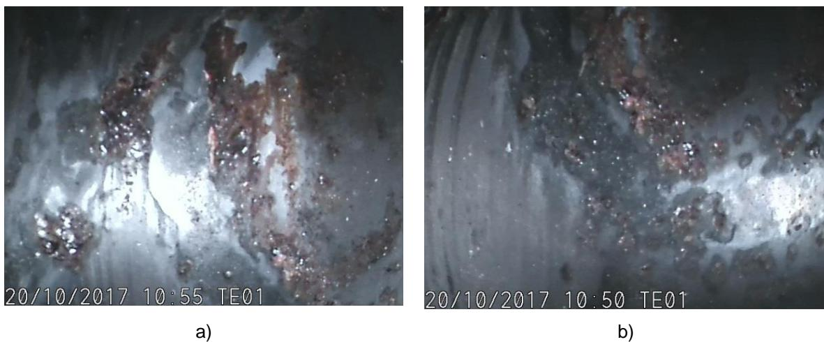
**Slika 14. Segment šasije FIREWALL: stanje unutrašnje površine cijevi gdje se vidi osnovni materijal.**
