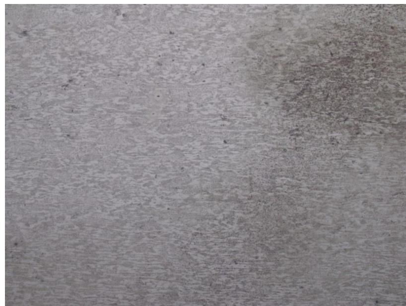
**Slika 59. Segment šasije PODNICA uzorak 4: mikrostruktura osnovnog materijala na poziciji OM2**
