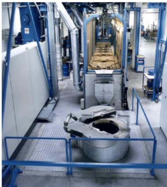
Slika 12. Automatizirano postrojenje za nitrokarburiranje s naknadnom oksidacijom u solnim kupkama (TENIFER QPQ) [8]
