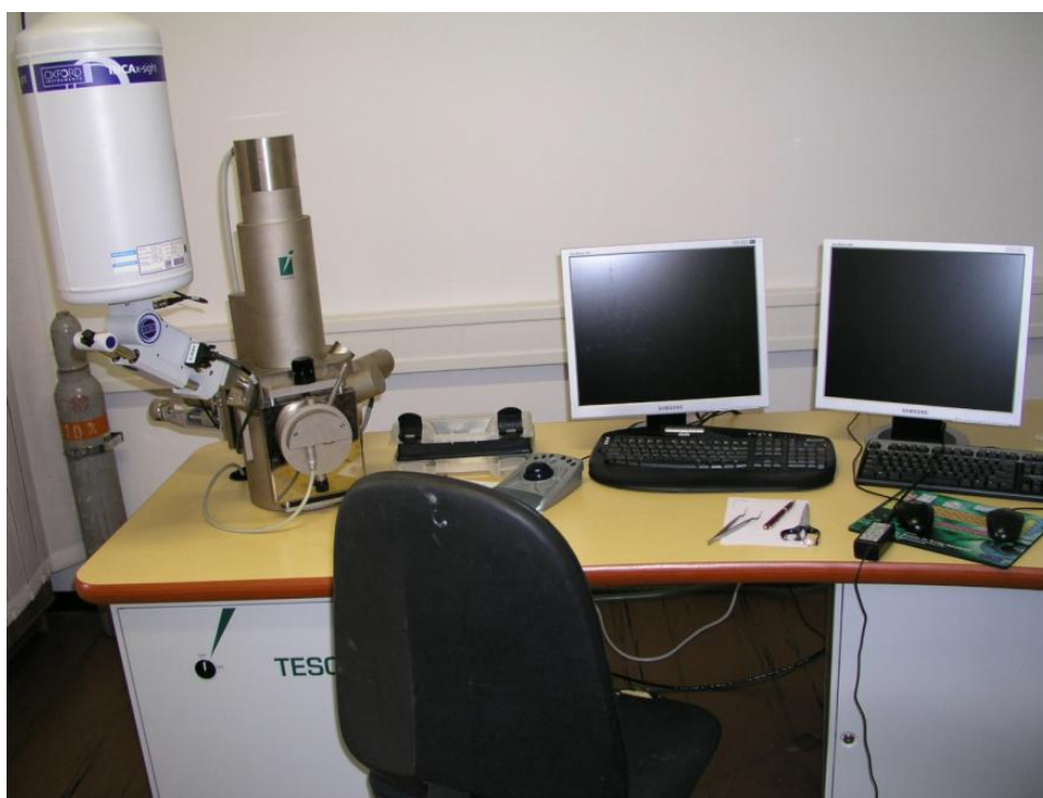
Slika 26. Skenirajući elektronski mikroskop (SEM) Tescan Vega TS5136LS[29]
