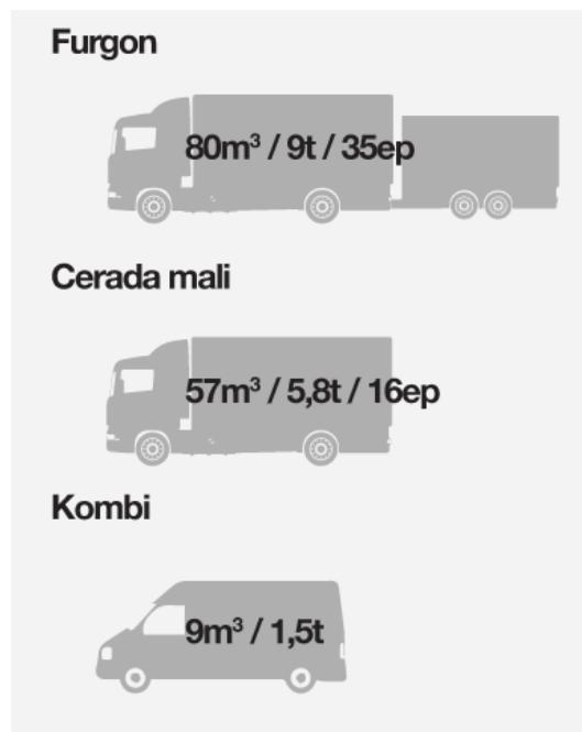
Slika 2.2. Vrsta, karakteristike i dimenzije vozila u floti [2]
