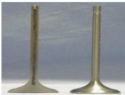
Slika 2.15 Ventili s Ti matricom ojačani SiC česticama[3]
