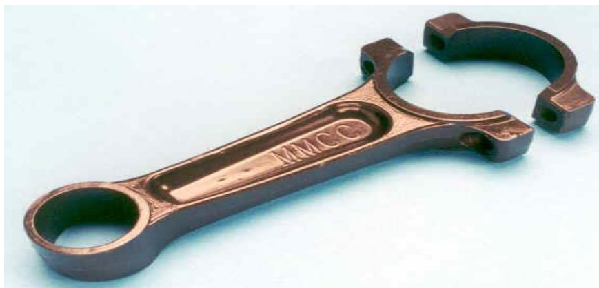
Slika 2.14 Klipnjača s Al matricom ojačana \text{Al}_2\text{O}_3 česticama[3]
