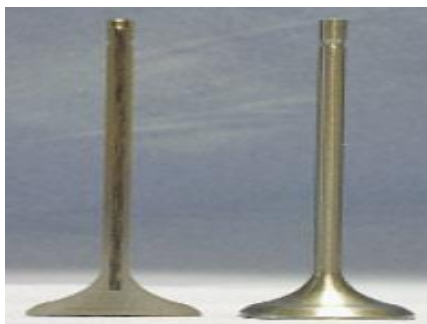
Slika 2.15 Ventili s Ti matricom ojačani SiC česticama[3]
