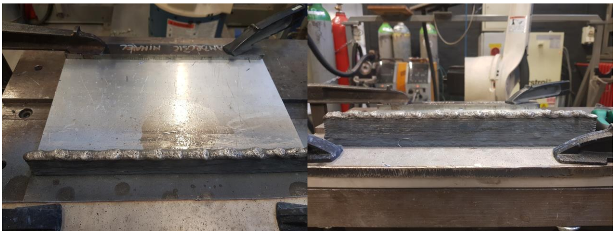
Slika 32. Novi problemi uzrokovani oštećenjem bužira
