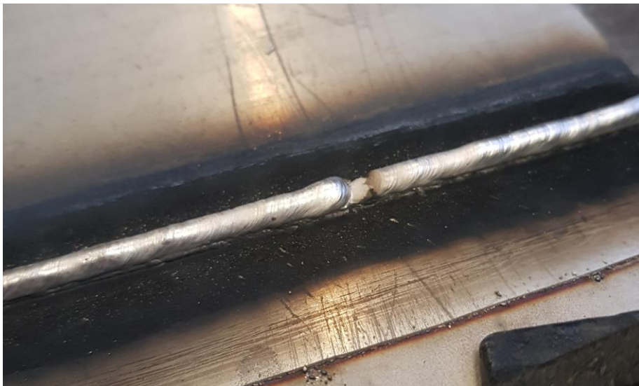
Slika 29. Nepravilnost zavora nastala uslijed nepravilnog dovoda žice
