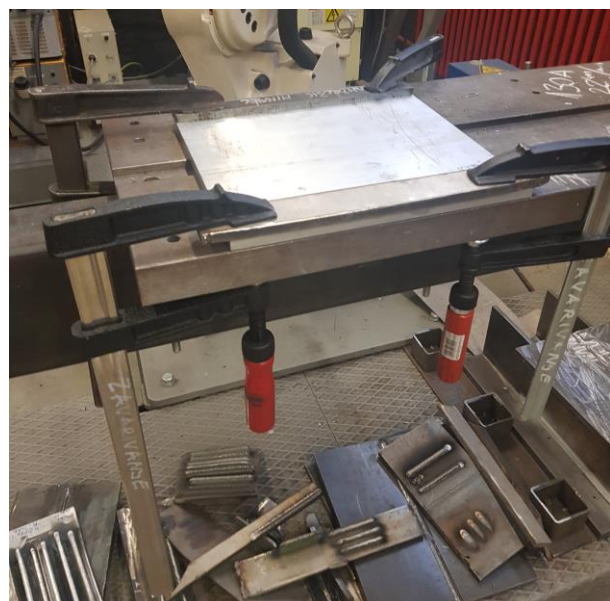
Slika 27. Pozicioniranje i stezanje osnovne ploče
