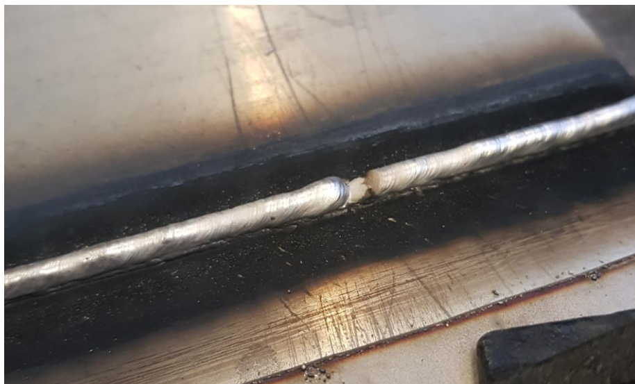
Slika 29. Nepravilnost zavora nastala uslijed nepravilnog dovoda žice
