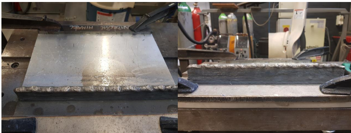
Slika 32. Novi problemi uzrokovani oštećenjem bužira
