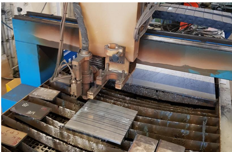
Slika 37. Odvajanje izrađenih zidova od osnovne ploče plazma rezačicom
