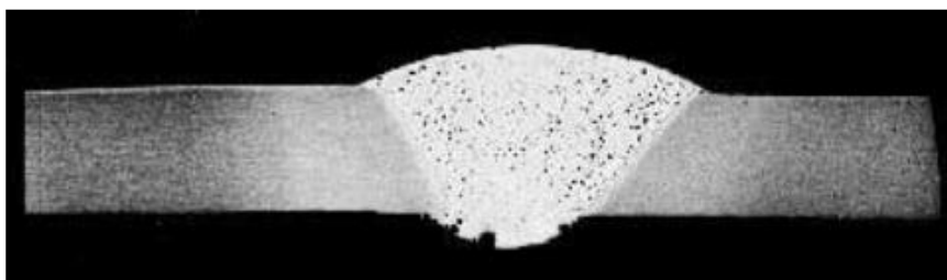
Slika 10. Poroznost u sučeljenom spoju aluminija debljine 6 mm (TIG postupak zavarivanja) [13]
