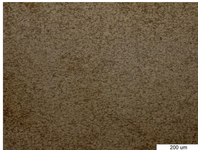
Slika 23. Mikrostruktura tibijalne komponente implantata prikazana svjetlosnim mikroskopom pri povećanju od 200x
