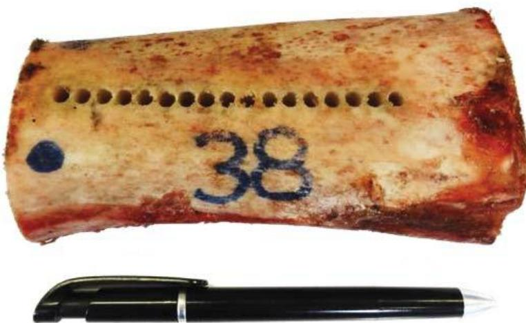
Slika 4.6. Ispitni uzorak nakon bušenja [1]
