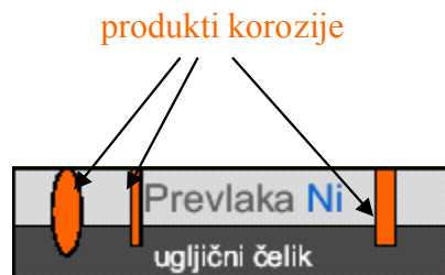
Slika 5. Katodna prevlaka nikla na čeliku [10]
