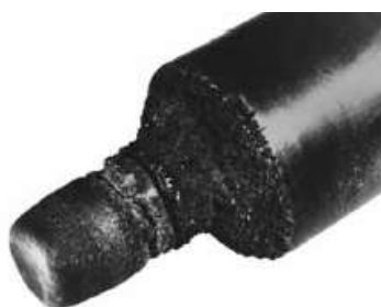
Slika 28. Karakterističan izgled nakon uništenja flashingom[2]
