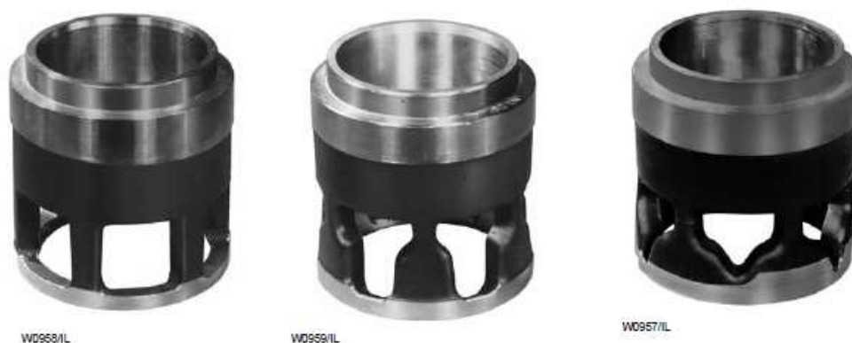
Slika 11. Karakteristični kavezi regulacijskog ventila; brzootvarajući, linearni, istopostotni [2]
