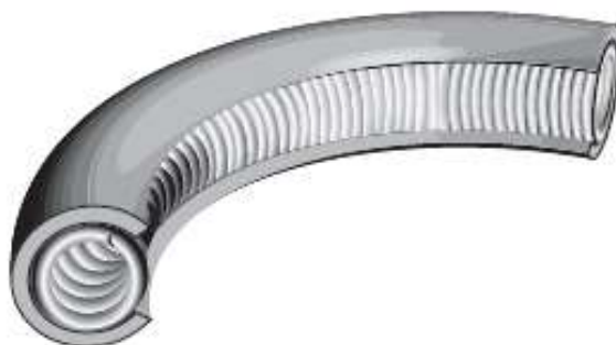
Slika 19. Metalna brtva s elastičnim prstenima [1]
